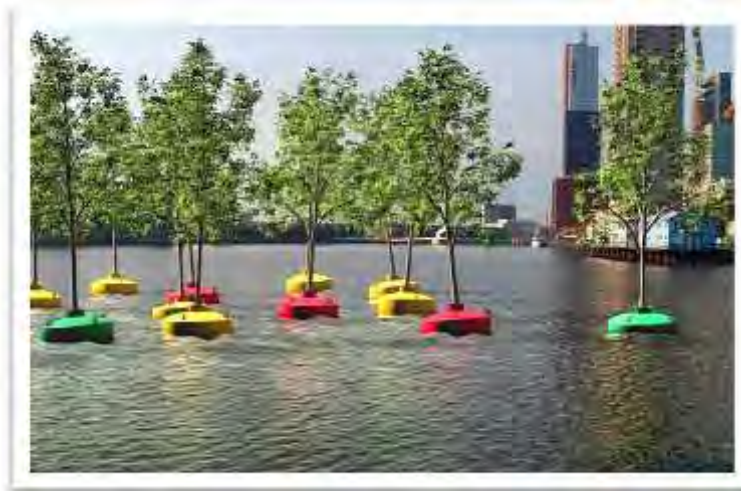
Gráfico N° 7: Boyas de acero como soportes de los arboles flotantes
