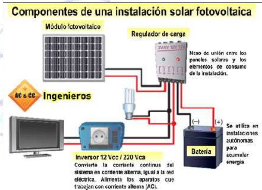
Imagen.5.-Componentes de una instalación solar fotovoltaica Fuente: Catalogo ENERSOL S.AS. BOLIVIA (05 de Diciembre 2020)
