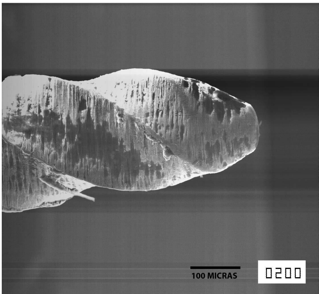
Figura 9. Lima Protaper Next 6 usos (x200), vista de corte tercio apical, se observa la presencia de: cráteres, deformación de punta, bordes irregulares, estrías, hoyuelos, microfisuras, presencia de detritus.
