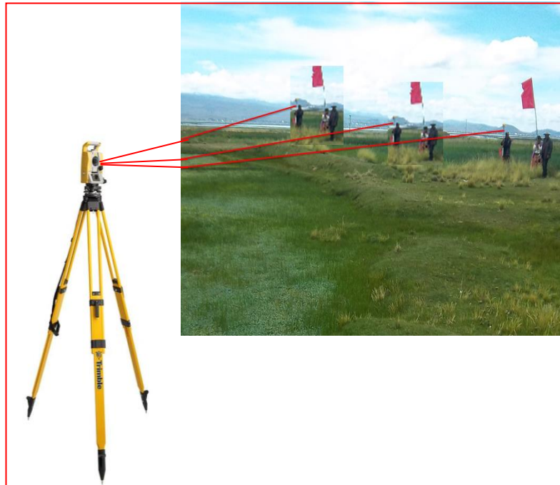
Figura No. 30: Mensura de parcelas con Estación Total Fuente: Elaboración propia
