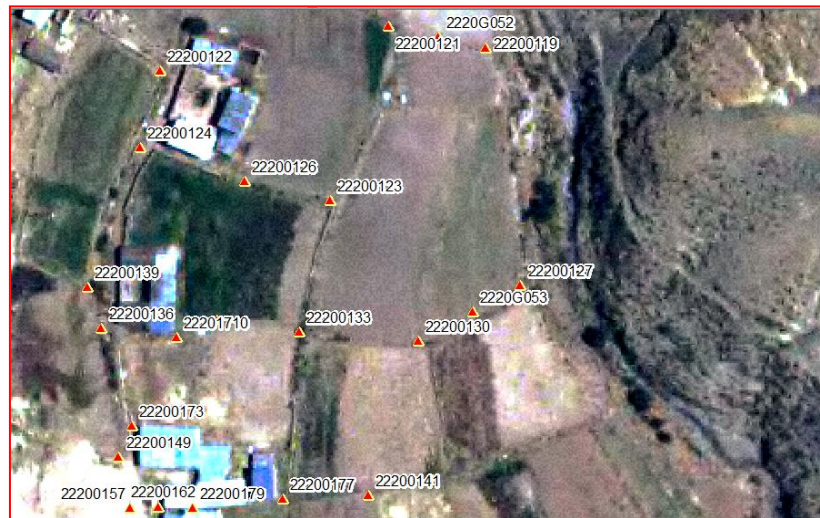
Figura No. 39: Nube de puntos del levantamiento Topográfico Fuente: Elaboración propia
