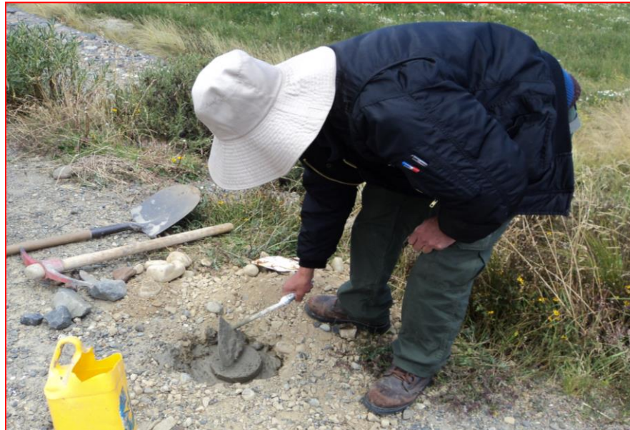
Figura No. 25: Monumentación del Punto de Control P1 Fuente: Elaboración propia
