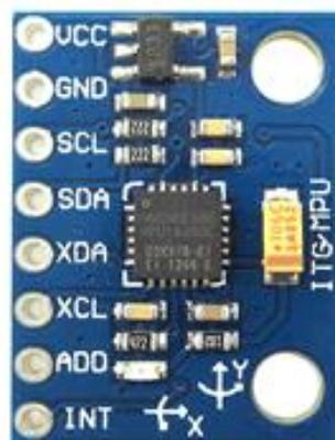
Figura 2.5. Sensor MPU-6050
