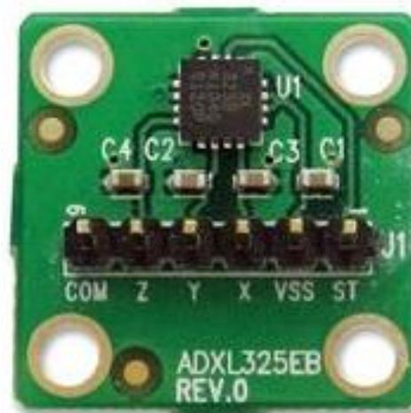
Figura 2.8. Sensor acelerómetro ADXL325
