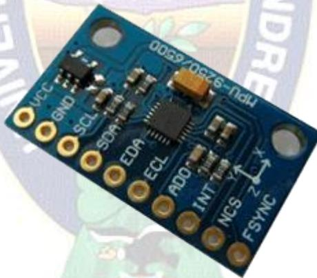
Figura 2.6. Sensor MPU-9250
