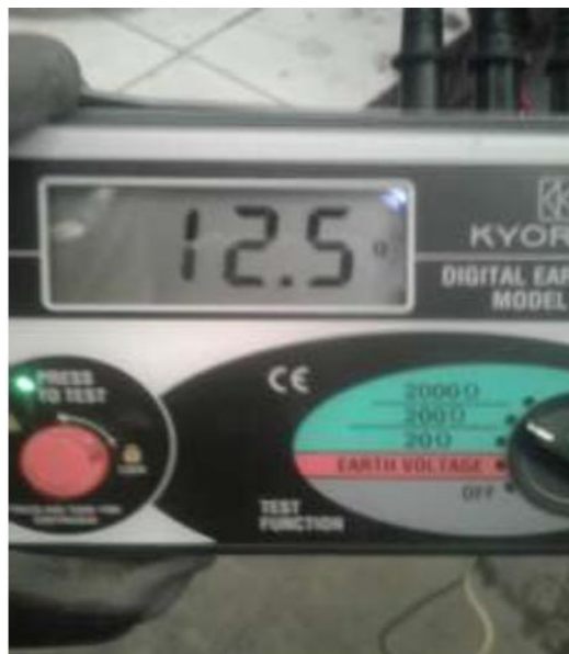
Figura 2. 63 Medición con Equipo Megger del Patio con tierra Húmeda a Mayor Distancia
