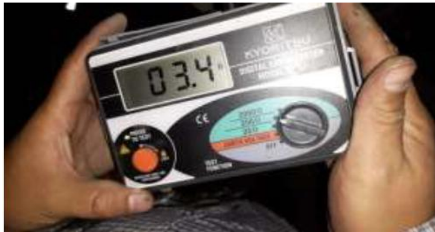
Figura 2. 69 Equipo Megger para medir la resistencia de la puesta a tierra
