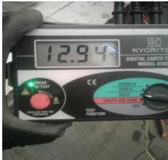
Figura 2. 62 Medición con Equipo Megger del Patio con tierra Seca a menor distancia
