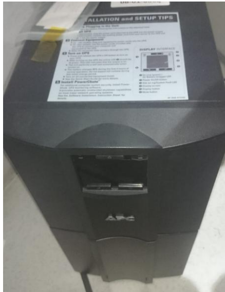
Figura 2. 56 Sistema de Energía Ininterrumpida modelo Smart-UPS C de APC, 2000 VA
