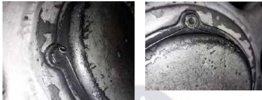
Imagen 118 Retire la tapa de la rueda
