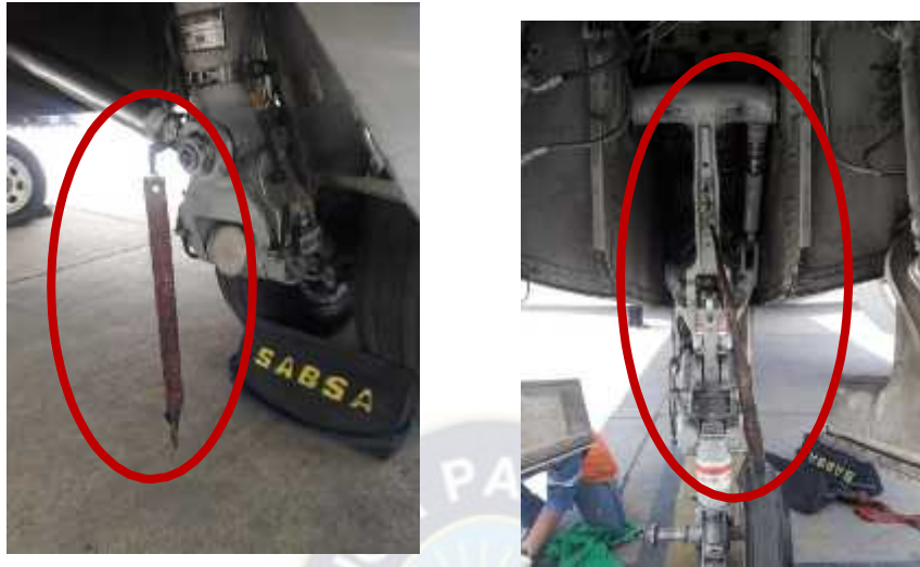
Figura 10 Instalacion de pines de seguridad al MLG también NLG
