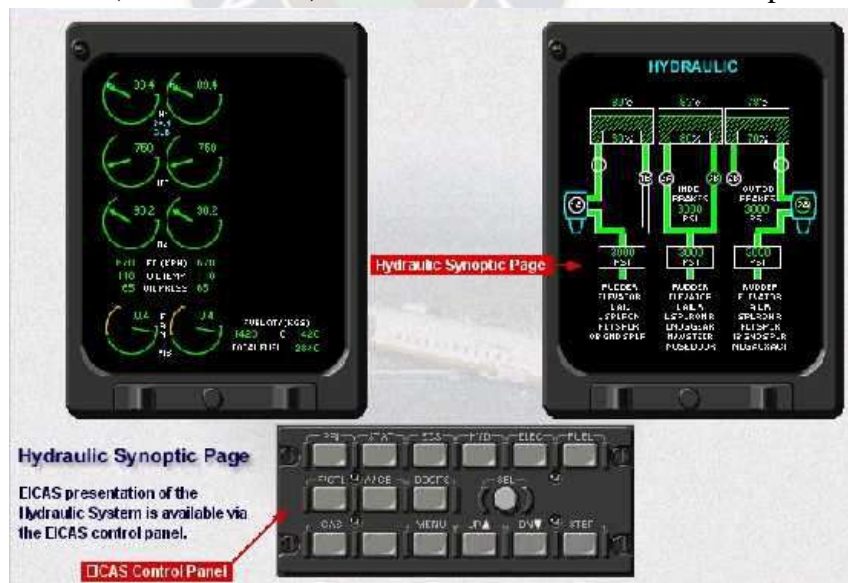
Imagen 34 Panel de control EICAS Y pantallas
