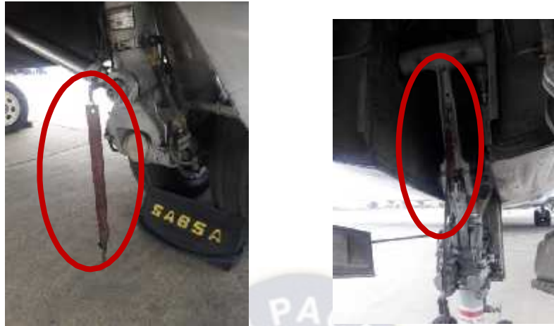
Imagen 114 Instalación de pasadores de seguridad
