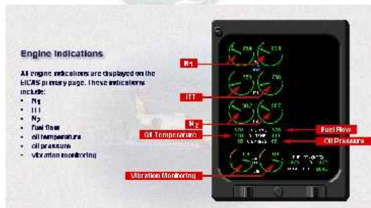
Imagen 8 Indicaciones del motor en EICAS
