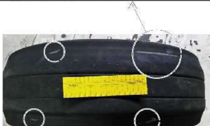
Imagen 106 Neumático que muestra lona en cuatro lugares diferentes
