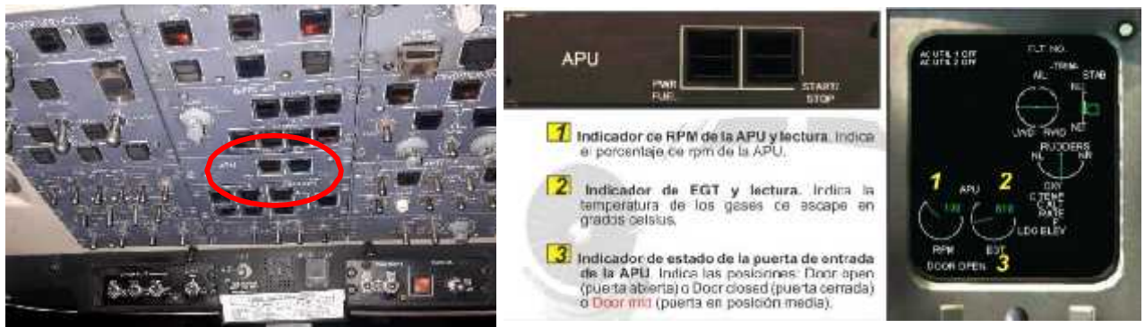
Imagen 15 Controles e indicadores del APU en el OVH panel
