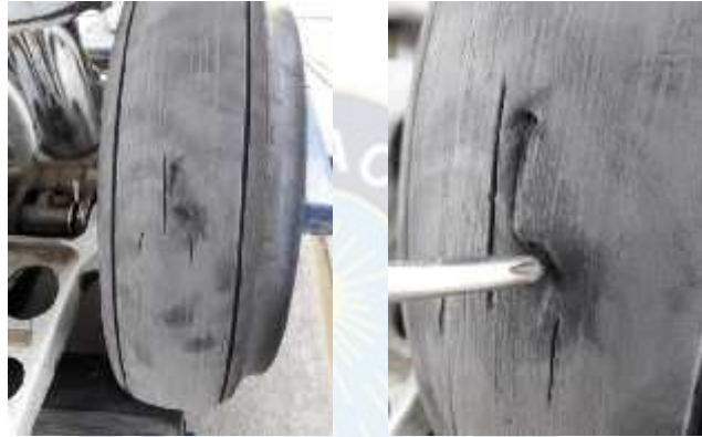
Imagen 110 Daño de pista
