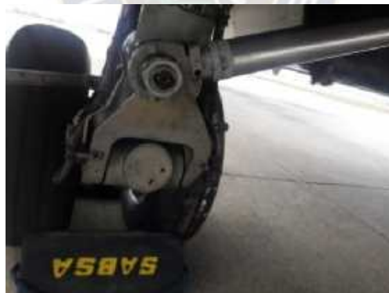
Imagen 113 Aplicación de calzos en MLG assy
