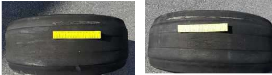
Imagen 107 Neumáticos que muestra lona
