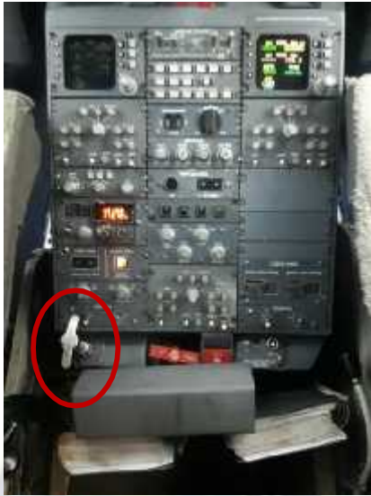
Imagen 112 Parking brake handle aplicado
