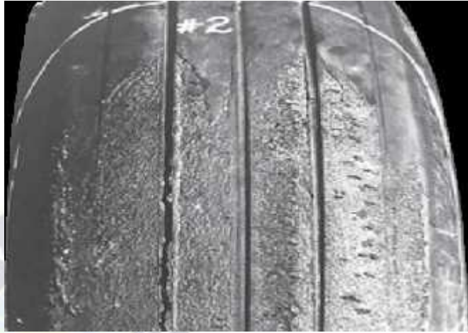
Imagen 96 Reversión de caucho de la banda
