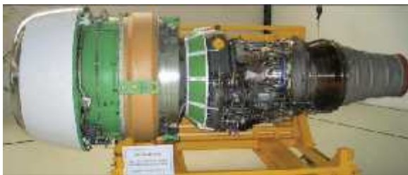
Imagen 9 Motores de turbofan de alta derivación General Electric CF34-3B1
