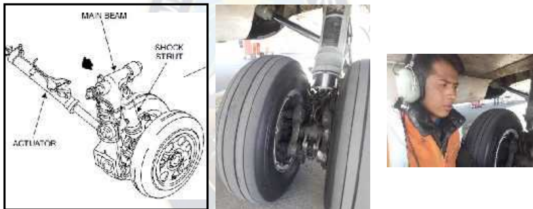
Imagen 52 Partes del MLG
