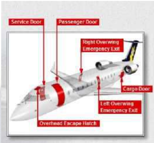
Imagen 13 Puertas y salidas de emergencia
