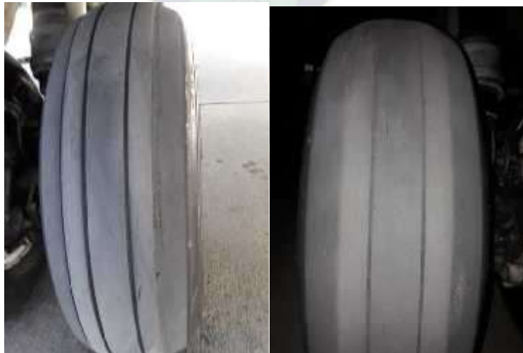
Imagen 92 Demasiado desgaste en la zona del hombro
