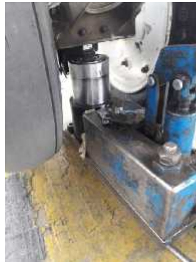
Imagen 121 Suspensión del NLG con gato hidráulico
