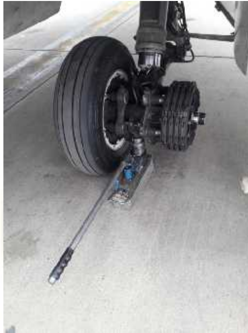
Figura 9 Rueda MLG desinstalada de la aeronave
