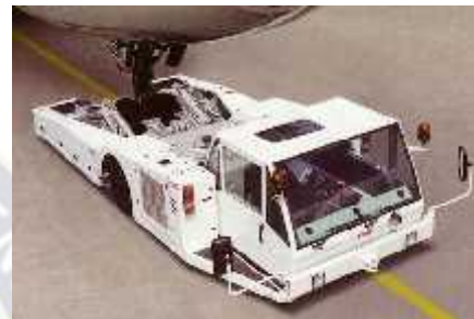
Imagen 40 Carro remolcador de alta velocidad, sin barra de remolque
