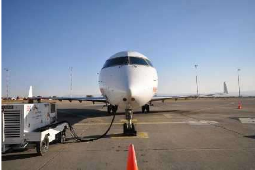
Imagen 128 Conexión de la planta externa
