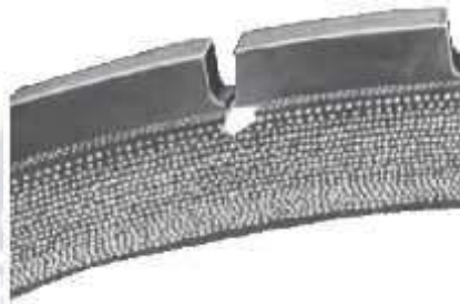
Imagen 86 Agrietamiento de surcos
