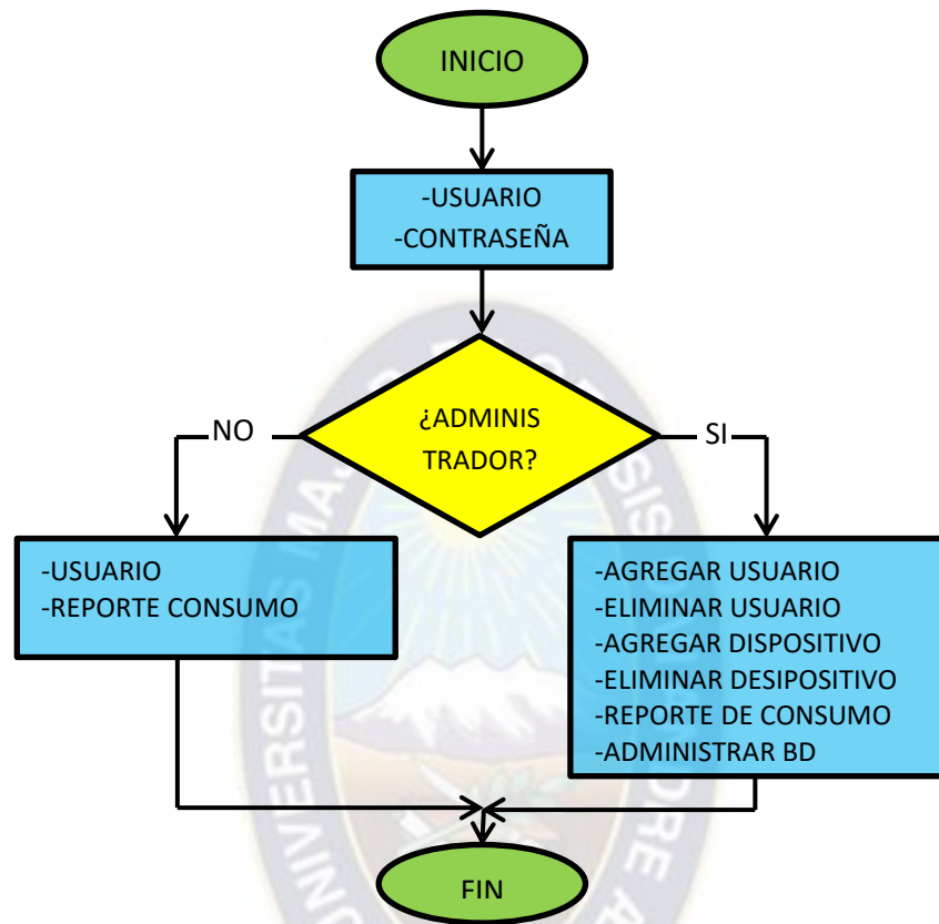
Figura N°47. Diagrama de flujo para el Login Fuente: Elaboración propia
