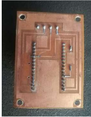
Figura N°82. Circuito implementado en PCB cara inferior Fuente: Elaboración propia
