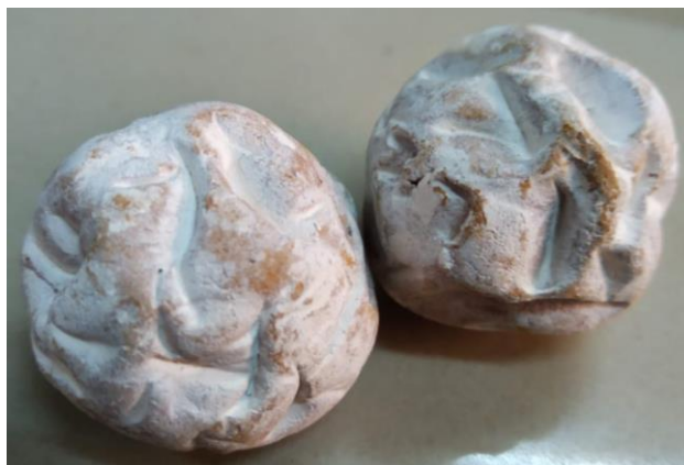
Figura 5. Fotografía de las perlas de arcilla realizadas manualmente con la inmovilización del TiO 2 al 2%.
