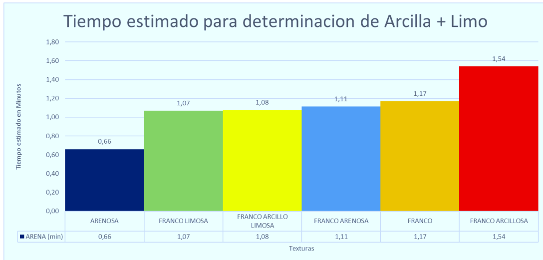
Gráfica 12. Tiempo estimado para la toma de datos en cuanto a la arcilla + limo, en la practica para la determinacion de textura por Curvas Granulometricas.
