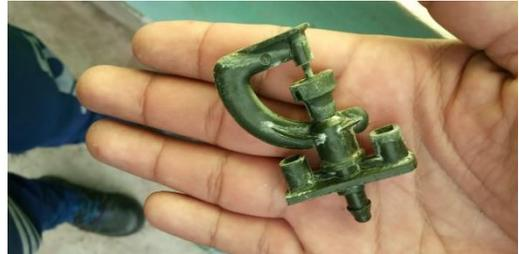
Micro aspersor de baja presión utilizado en el sistema de riego.
