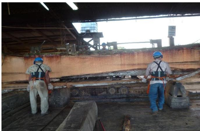
Obtención de las tablas de 2 pulgadas de espesor
