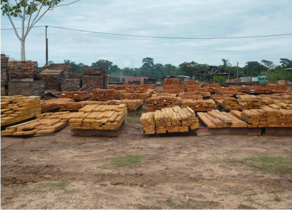
**Apilado y ordenamiento de los paquetes de madera aserrada según las trozas procesadas de palo maría**
