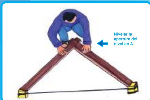
**Cuarto paso:** Colocar las reglas en cada estaca para guiar la apertura del nivel en "A".
