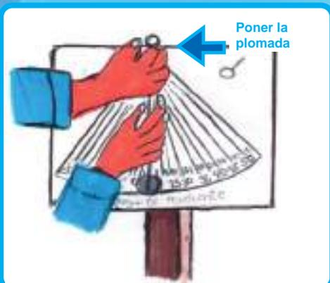
**Segundo paso:** Sujetar la plomada con una cuerda al gráfico del triángulo de pendientes, de tal forma que la plomada tenga libre movimiento.
