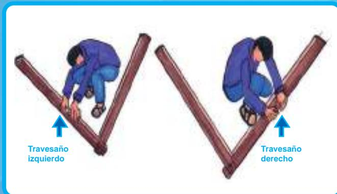
**Segundo paso:** Para marcar donde ira el travesaño (madera al medio), se amarra la cuerda al clavo y con ésta extendida se debe realizar la marca a igual distancia en cada madera.
