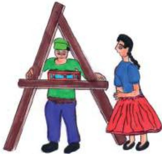
**Quinto paso:** Se sujeta el nivel de burbuja al travesaño con una cuerda y con un lápiz se procede a marcar la posición del nivel en la regla horizontal.
