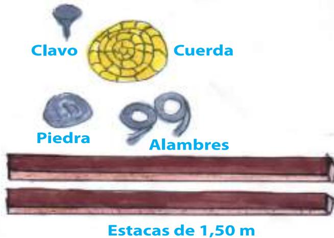
*Materiales para la construcción del triángulo de pendientes.*
