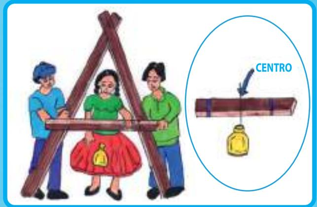
**Cuarto paso:** Si se utiliza un nivel de burbuja entonces se coloca el nivel "A" sobre las estacas y el nivel de burbuja se coloca en el centro de la regla horizontal.
