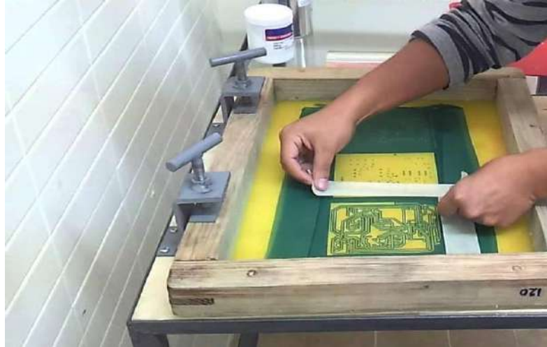
FIGURA 4.3: Serografiado del circuito impreso PCB
