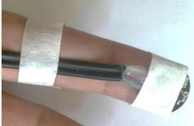
FIGURA 4.15: Colocado del sensor de ritmo cardiaco
