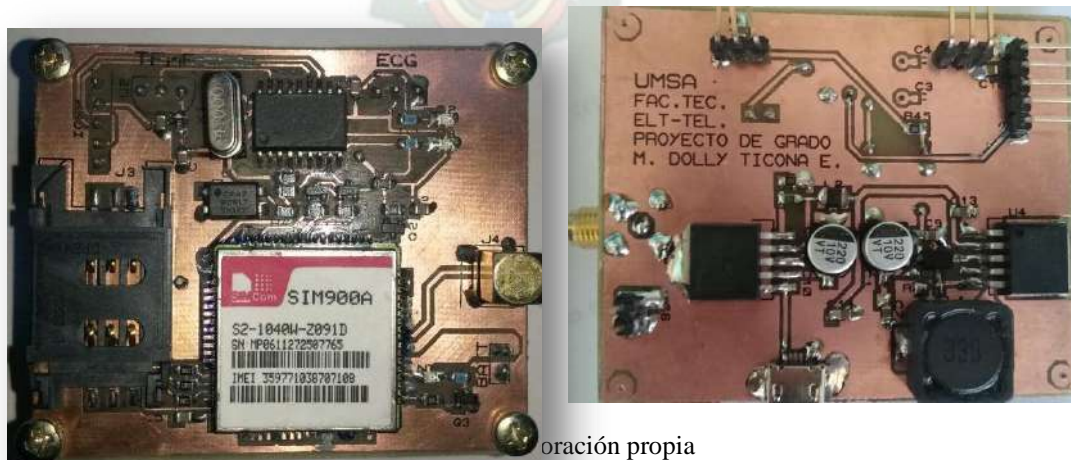
FIGURA 4.7: Montaje y soldadura de componentes
