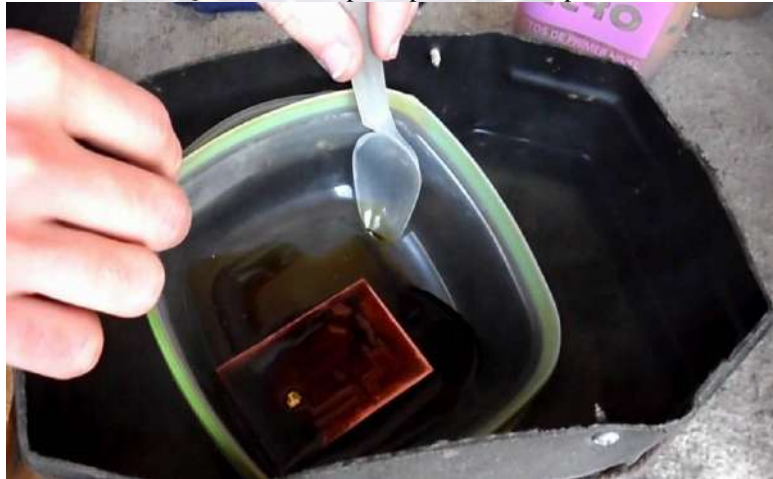
FIGURA 4.4: Quemado de la placa pcb con ácido perclorato de ferro
