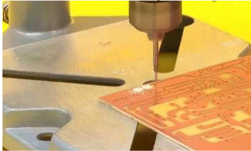
FIGURA 4.5: Perforación de placas PCB
