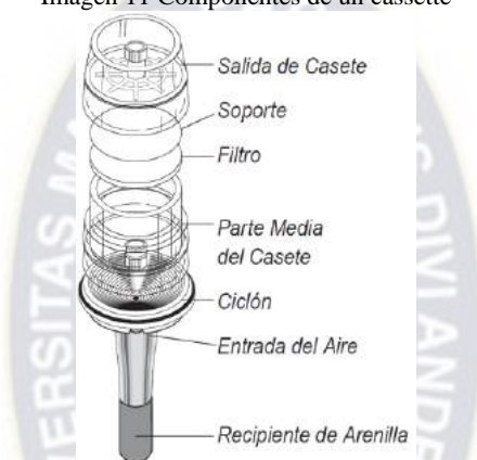
Imagen 11 Componentes de un cassette
