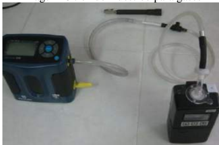
Imagen 18 tren de muestreo para gases
