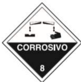
FIGURA 5-44. Identificación de las sustancias corrosivas.
