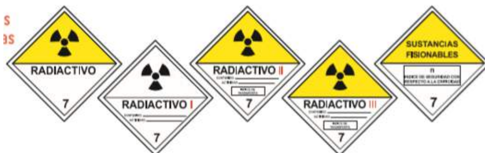
FIGURA 5-43. Identificación de las sustancias radioactivas.
