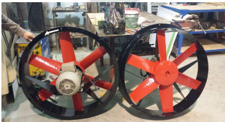
FIGURA 6-2. Ventiladores axiales comprados para la implementación en las áreas de Irupana S.A.
