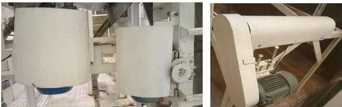
FIGURA 5-35. Protección a motores y partes móviles en la maquinaria de la empresa
