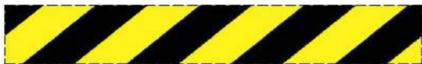
FIGURA 5-31. Señalización en suelos para áreas productivas y almacenamiento según NB - 55001
