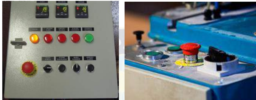
FIGURA 5-64. Botones de emergencia en las líneas de procesamiento de la empresa Irupana S.A.
