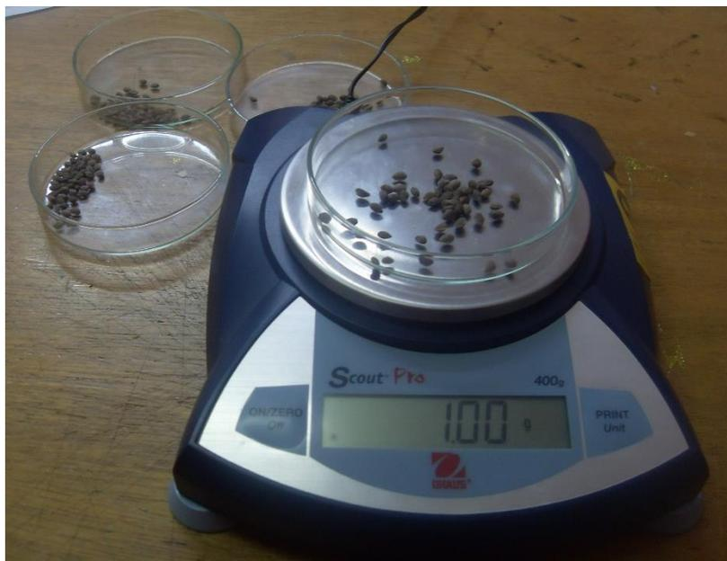
**Anexo 8.** Determinación del contenido de humedad mediante el secado
