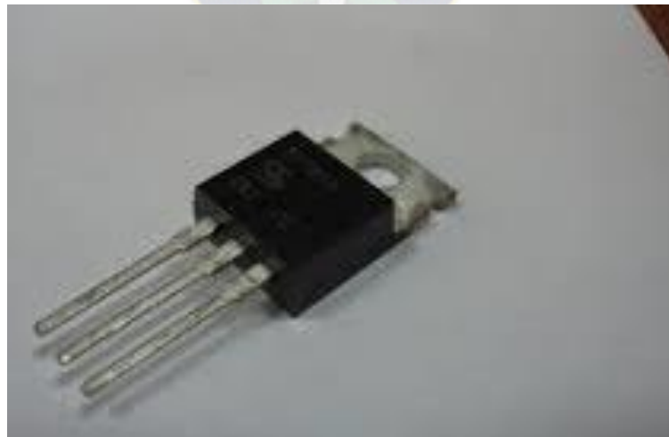
Figura: 24 Conectores de regulador de voltaje
