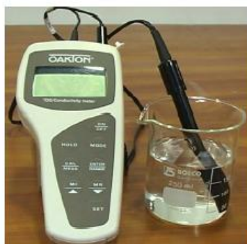
CONDUCTÍMETRO DE CAMPO Y DATOS DE CALIBRACIÓN. FUENTE: AUTOR
