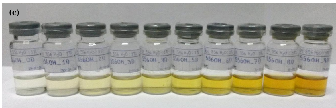
Figura N° 25: Cambio de coloración de las muestras de oxo – alcoxido de titanio durante el crecimiento de las partículas a tiempos distintos para una relación molar H_2O/titanatrano igual a (a) 139, (b) 278 y (c) 556.
