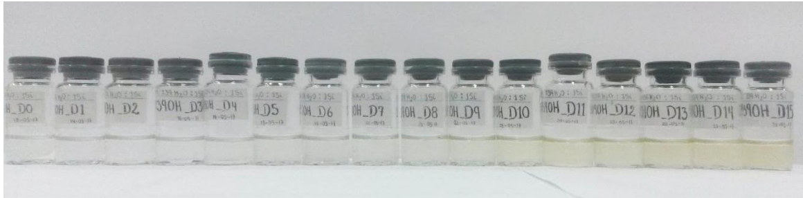
Figura N° 34: Muestras de partículas oxo - alcoxido de silicio a obtenidos en función del tiempo
