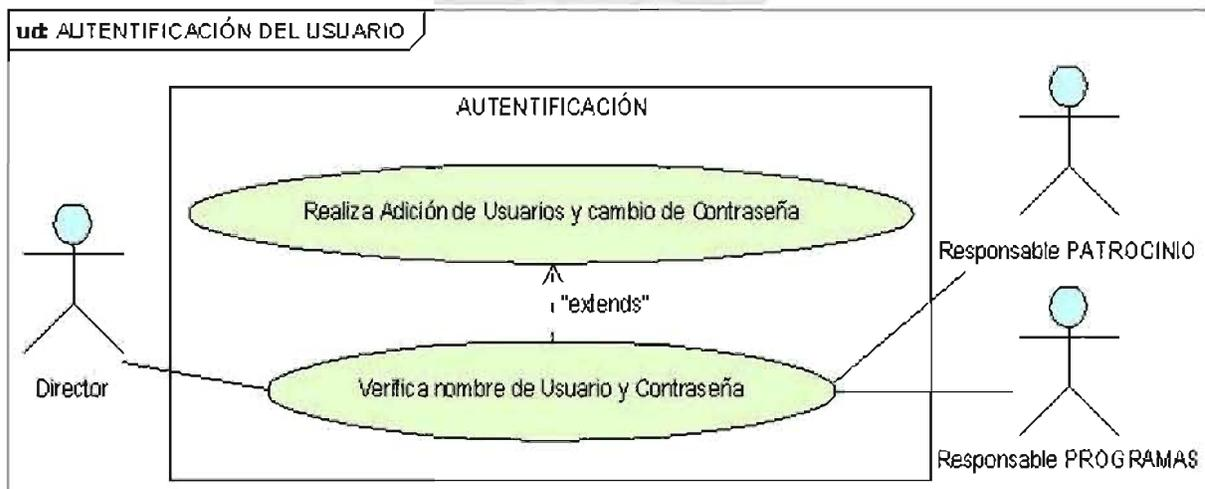
**Figura 3.10** Diagrama de CU del Sistema, Autenticación
