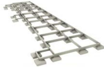
Foto: Zapatas y vigas de Fundación
