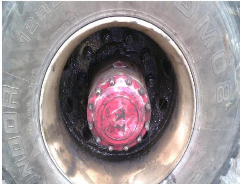
**FIG. 17 Imagen fuga de aceite de reten palier eje trasero de Bus**
