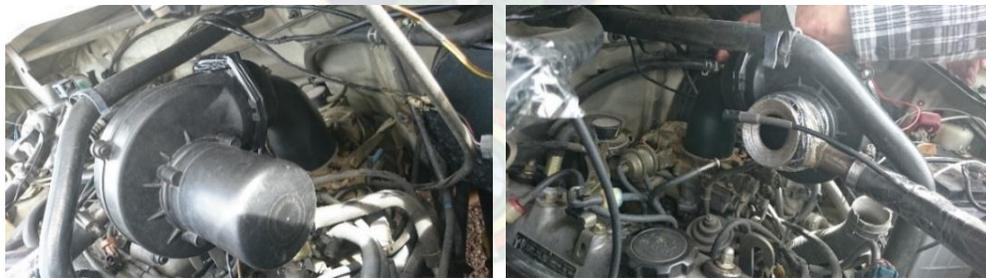
Figura 18 Filtro del compresor eléctrico
