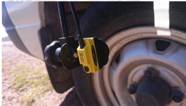
Figura 7 Sensor en el soporte del brazo telescópico
