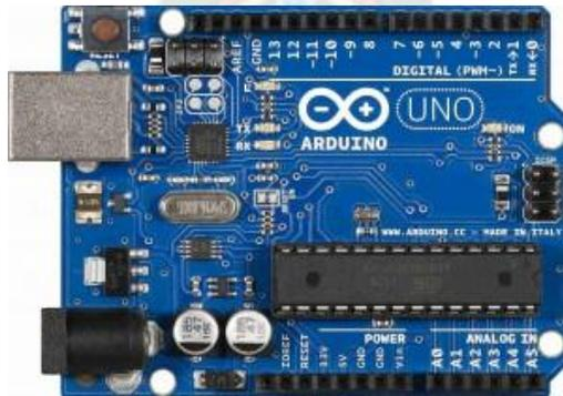
Figura N°10 Placa Arduino Uno R3
