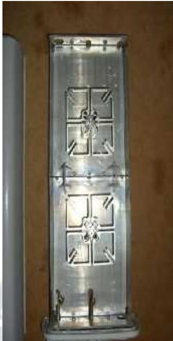
*Figura 3.77 Vista del Interior de una Antena Sectorial Kathrein*
