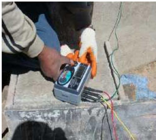
*Figura 3.14 Medición de la Resistividad*
