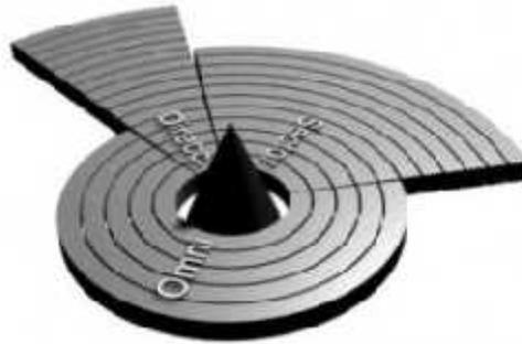
*Figura 3.72 Comparación del Haz de la Antena Sectorial con las Antenas Direccional y Omnidireccional*
