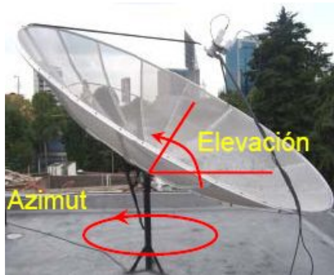
Figura 10 Movimiento de la antena parabólica
