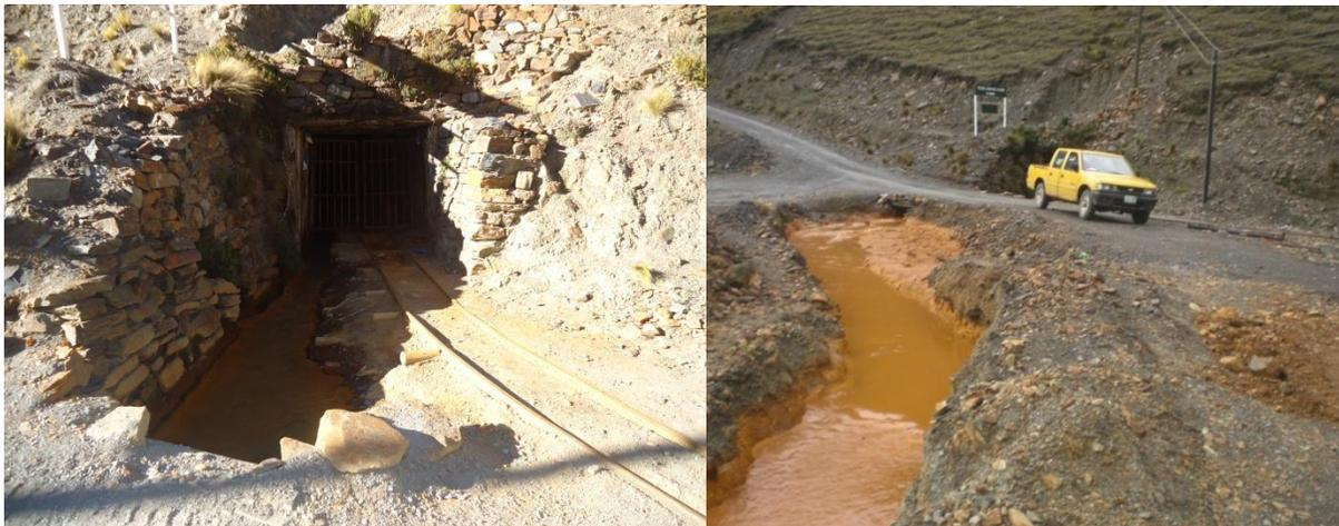
**Foto N° 4:** Salida de aguas ácidas de la bocamina (nivel -180)
