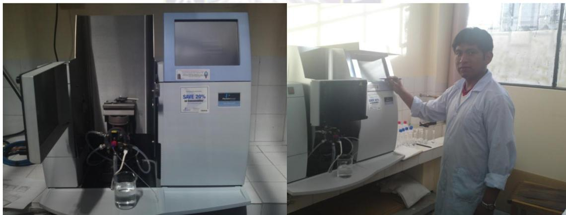
Foto N°17: Espectrómetro Perkin Elmer AAnalyst 200, de llama.
