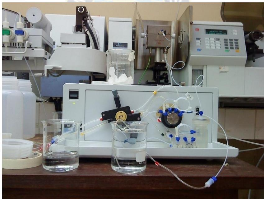
Foto N°19: Espectrómetro Perkin Elmer AAnalyst 100, generador de hidruros.
