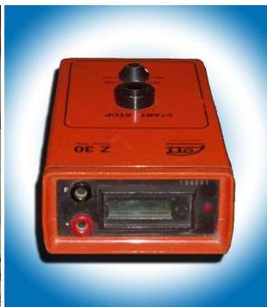
Foto N° 7: Micromolinete y contador de revoluciones Z 30.
