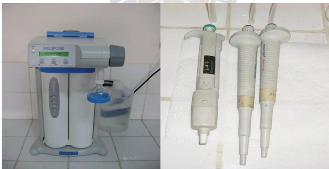
Foto N° 12: Desionizador de agua destilada y micropipetas Eppendorf
