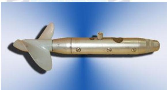
Foto N° 6: Contador de revoluciones marca SIAP y molinete de eje horizontal marca SIAP
