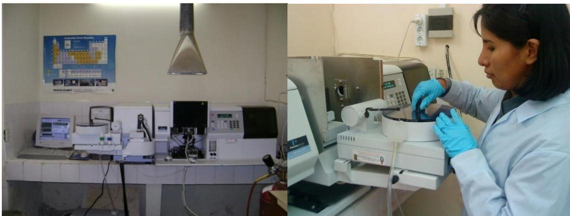
Foto N°18: Espectrómetro Perkin Elmer AAnalyst 100, horno de grafito.
