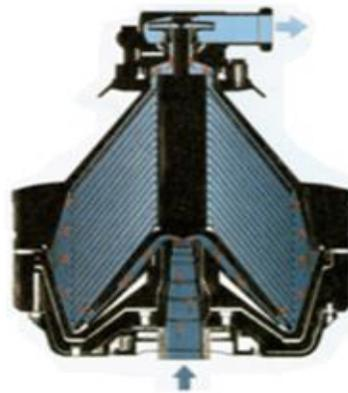
**Fig. 6 Clarificadora Centrífuga**
