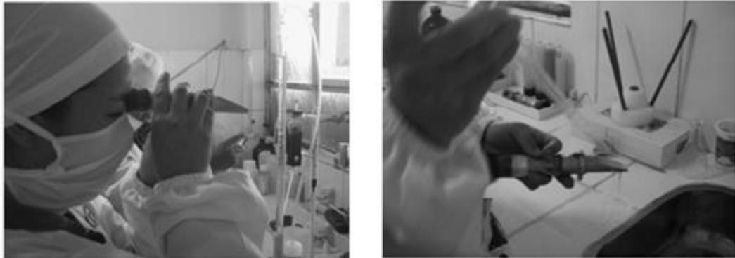
**Determinación de Sólidos Totales Uso del Refractómetro**
