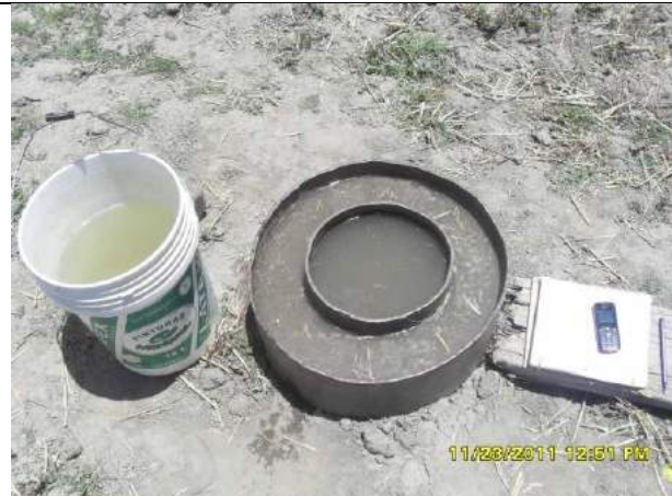
Lecturas y registro de infiltración
