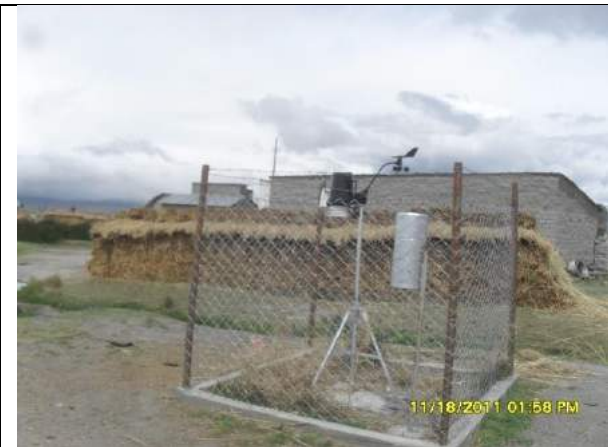
Estación meteorológica automática DAVIS Vantage Pro 2, que provee datos de forma inalámbrica.
