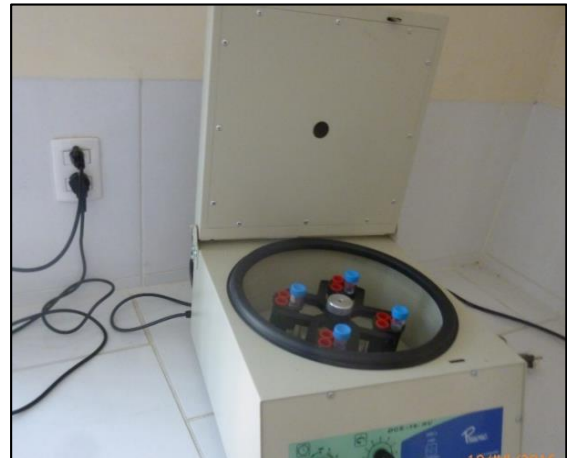
Fotografía 23. Primera centrifugación a 3500 rpm durante 3 minutos
