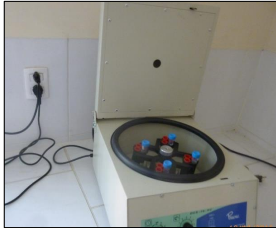
Fotografía 27. Segunda centrifugación a 3000 rpm durante 3 minutos
