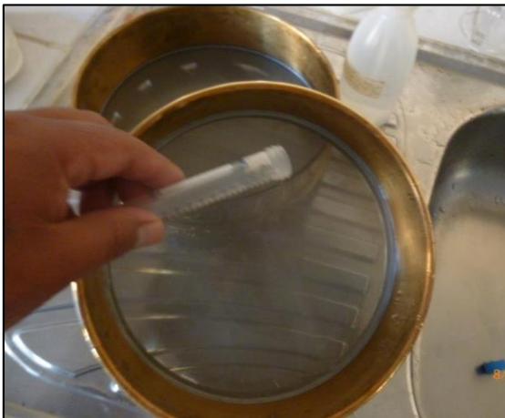
Fotografía 28. Tubos de la centrifugadora se decantan sobre el tamiz de 400 mesh
