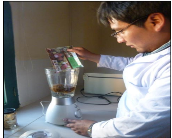
Fotografía 17. Licuado de las raíces durante 30 s en dos fases a 3500 y 3000 rpm
