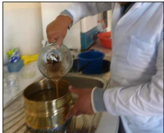
Fotografía 19. Vaciado del licuado en tamices de 100 y 400 mesh sobrepuestos
