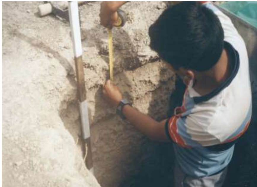
Fotografía 4. Apertura y descripción de calicatas
