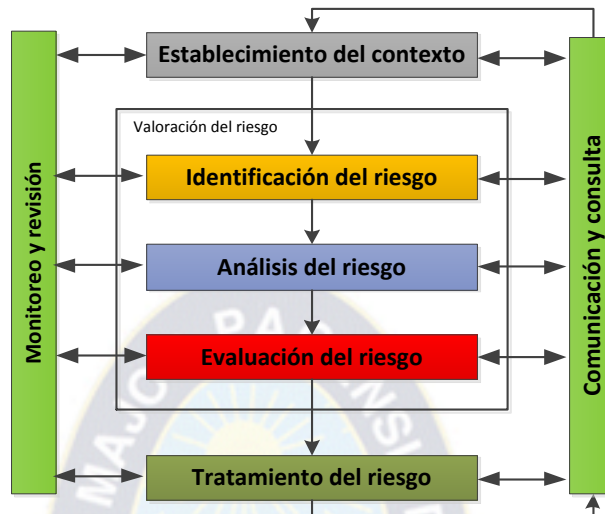
Fig. 2.10 Proceso de gestión del riesgo según la norma AN/NZS 4360:2004 Fuente: Norma Boliviana NB/ISO 31000. Gestión del riesgo –Principios y directrices.
