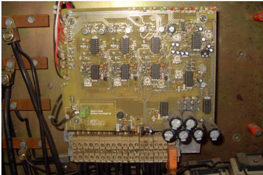
Fig. 4.18 Circuito regulador de carga Fuente: Fotografía (Santa Rosa de Quilo Quilo)
