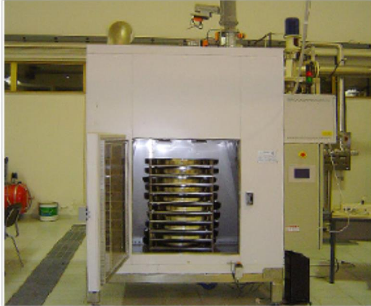
FIGURA 6. Típico secador de bandejas
