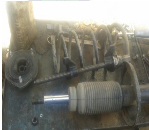
Foto N° 42 Despiece del amortiguador
