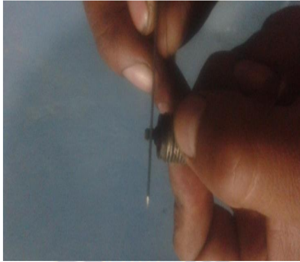
Foto N° 11 Calibrado de bujías
