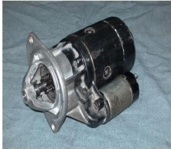
Foto N° 81 Motor de arranque armado
