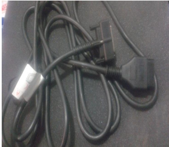
Foto N° 25 Cables de conexión del escáner
