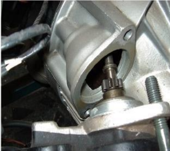
Foto N° 60 Extracción del arrancador
