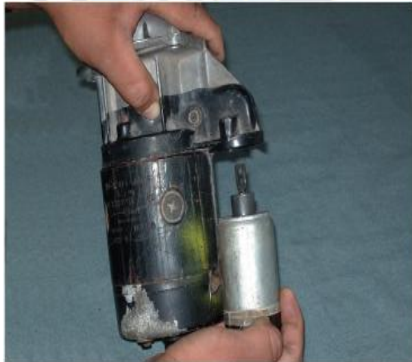
Foto N° 64 Extracción del solenoide
