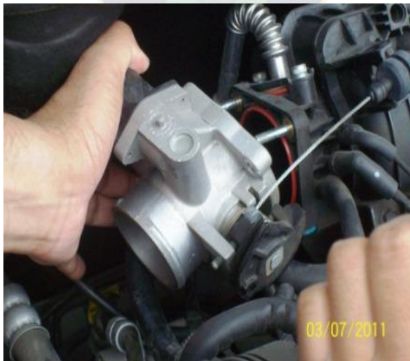
Foto N° 9 Extracción del obturador
