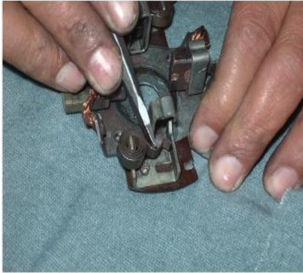
Foto N° 69 Inspección del los muelles
