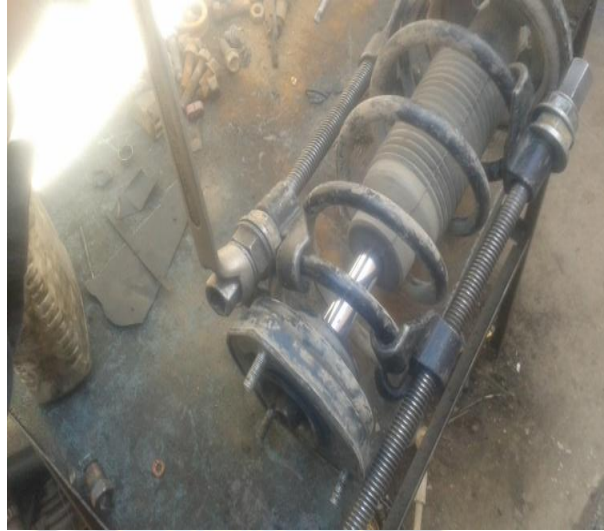
Foto N° 41 Ajuste de las garras de compresión
