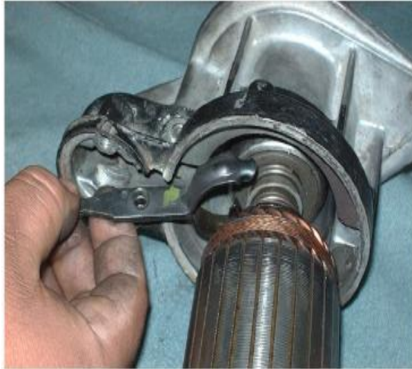
Foto N° 71 Extracción de la horquilla
