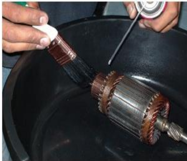
Foto N° 74 Limpieza del rotor
