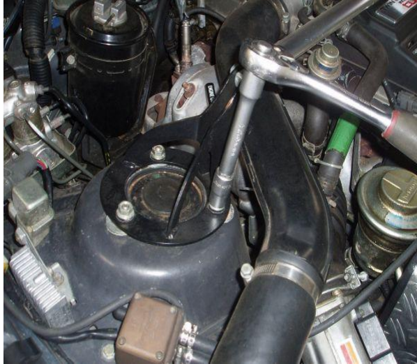
Foto N° 38 Desajuste de pernos del chasis
