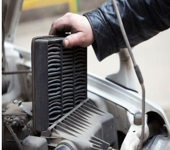
Foto N° 8 Extracción del filtro de aire
