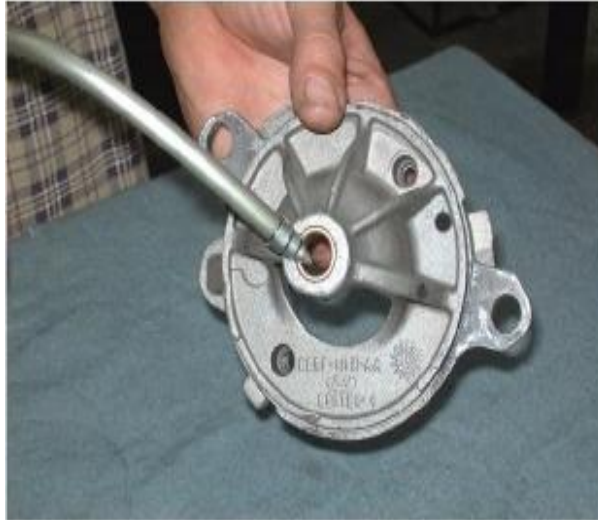
Foto N° 79 Lubricación del buje
