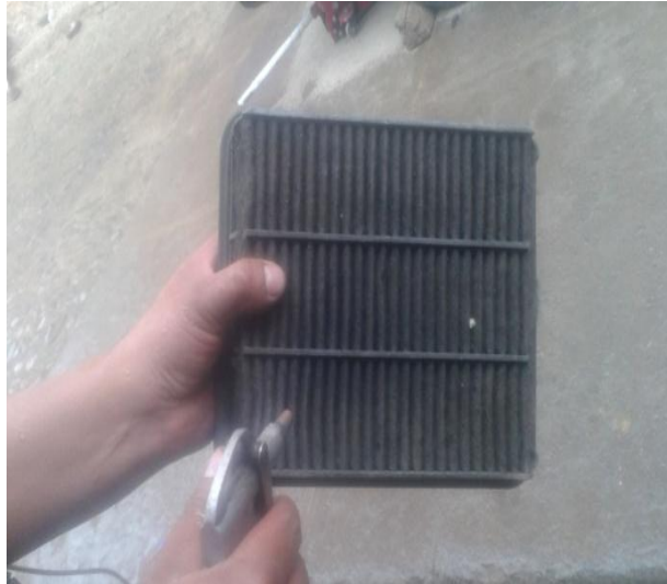
Foto N° 13 Limpieza del filtro de aire
