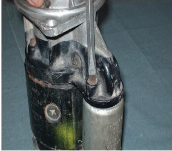
Foto N° 63 Desajuste de pernos del bendix
