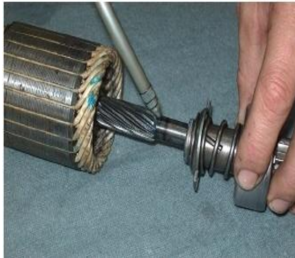
Foto N° 80 Lubricación del eje
