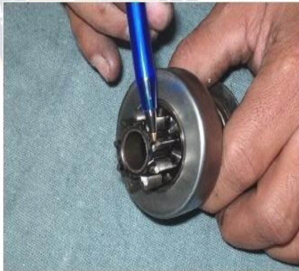
Foto N° 78 Inspección del módulo del bendix
