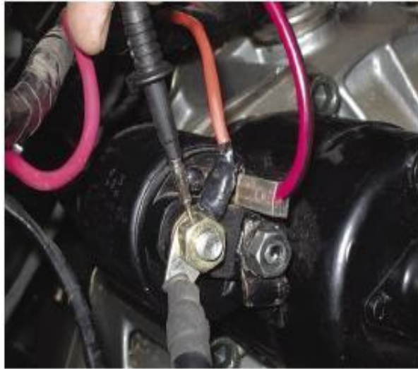
Foto N° 51 Prueba del conductor positivo
