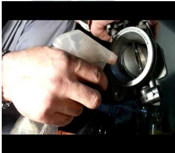
Foto N° 14 Limpieza del obturador
