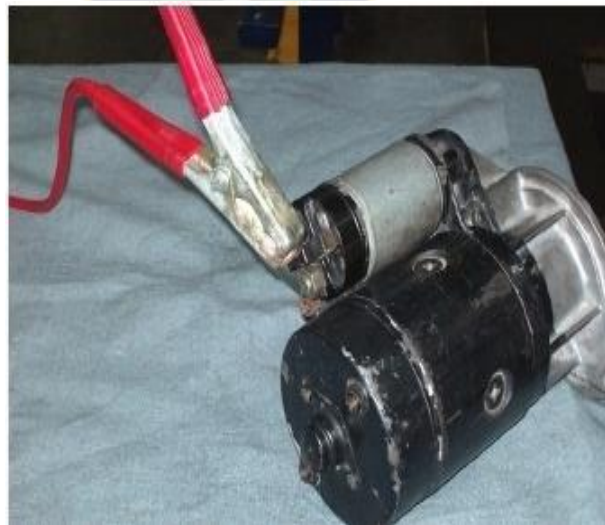
Foto N° 84 Prueba del motor de arranque
