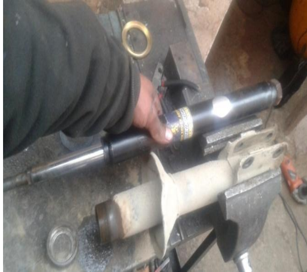
Foto N° 43 Extracción del vástago
