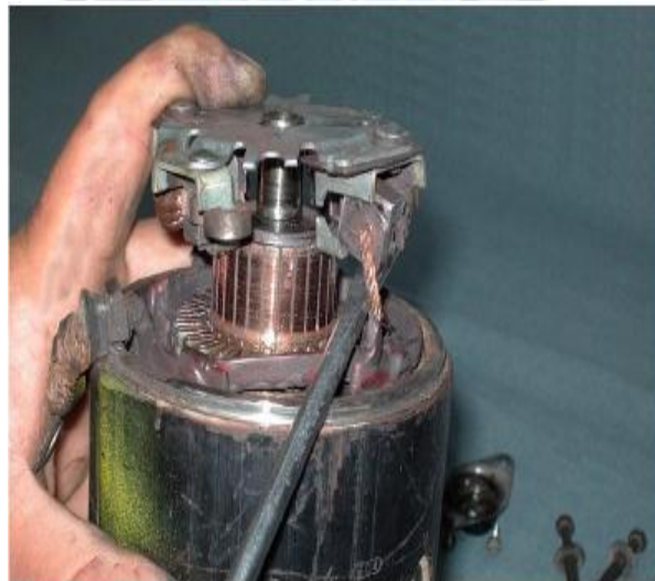
Foto N° 66 Extracción de las escobillas
