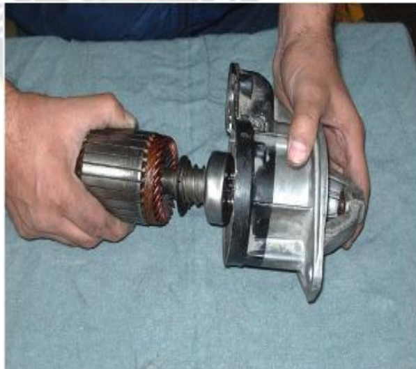
Foto N° 70 Extracción del campo y del bendix
