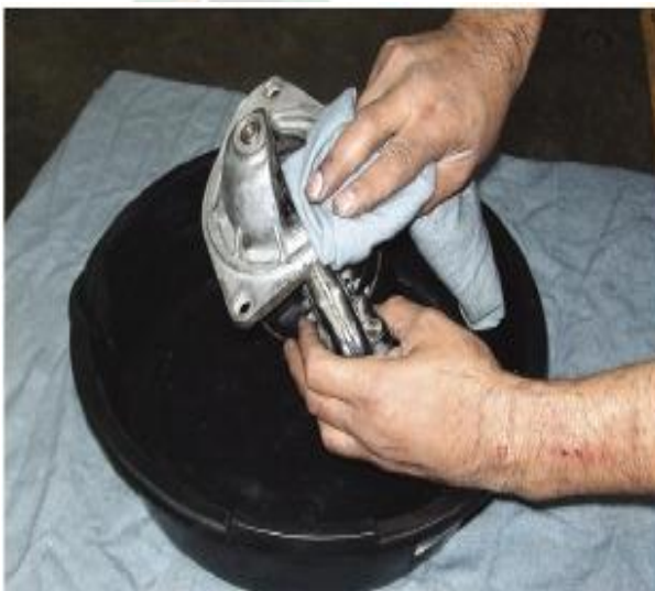
Foto N° 61 Limpieza con gasolina
