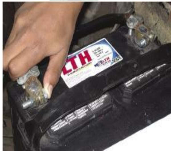
Foto N° 4 Verificación del borne
