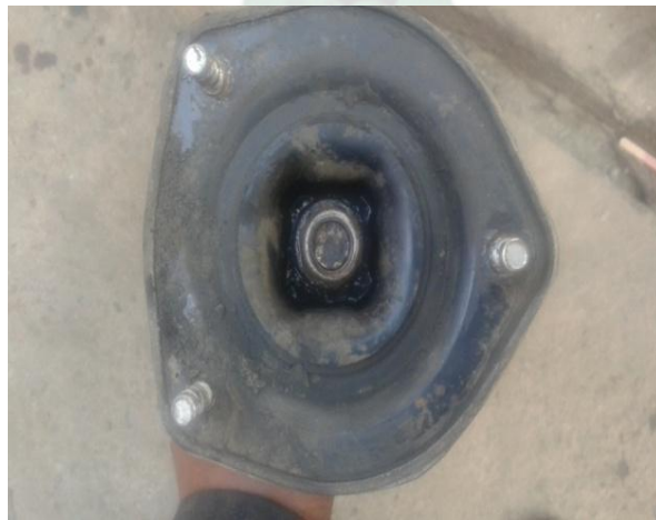
Foto N° 39 Desajuste del perno central
