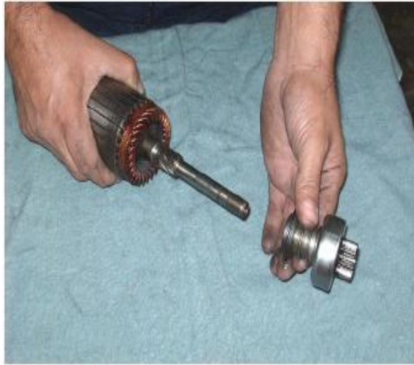
Foto N° 73 Desacople del bendix
