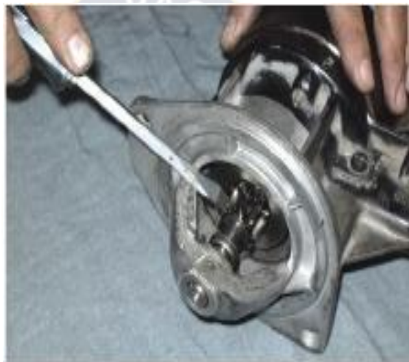
Foto N° 62 Prueba del bendix
