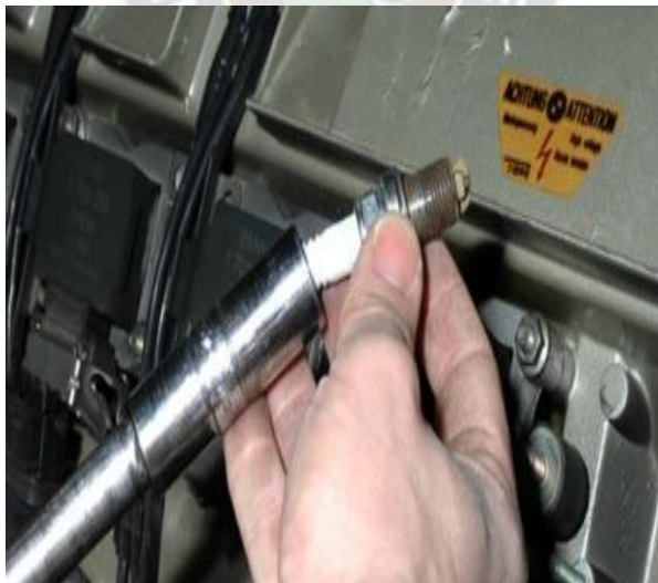
Foto N° 7 Extracción de la bujía
