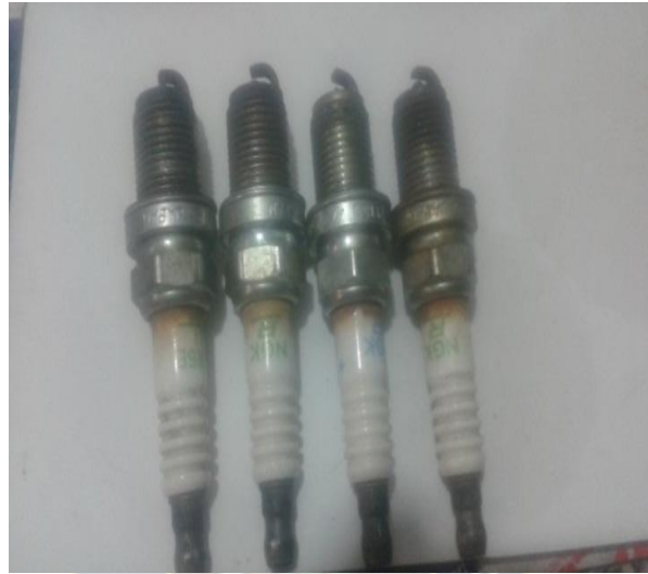
Foto N° 10 Bujías en mal estado
