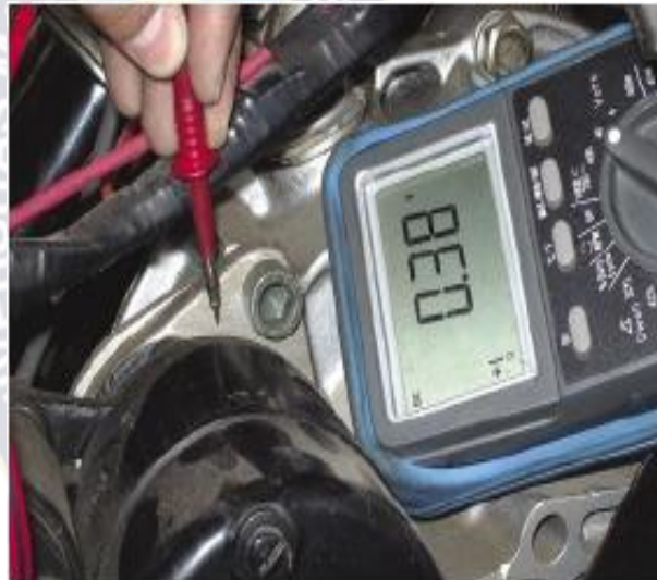
Foto N° 53 Prueba del conductor negativo
