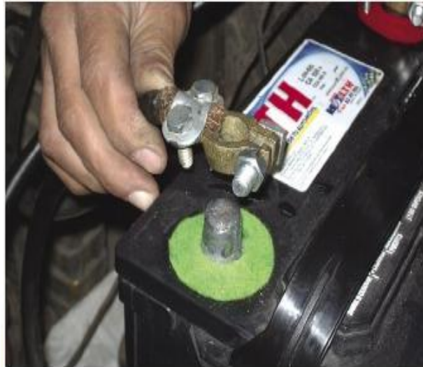
Foto N° 56 Retirar los bornes de la batería
