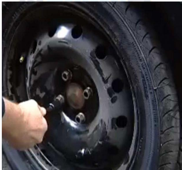
Foto N° 37 Desajuste de pernos de la rueda
