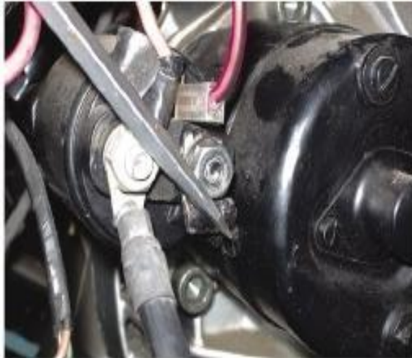
Foto N° 54 Prueba de contacto del bendix
