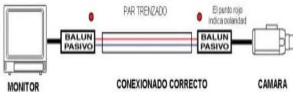
**Figura 7** Forma de conexión de los baluns
