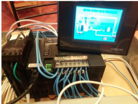
**Figura 5:** Prueba del HMI con el PLC
