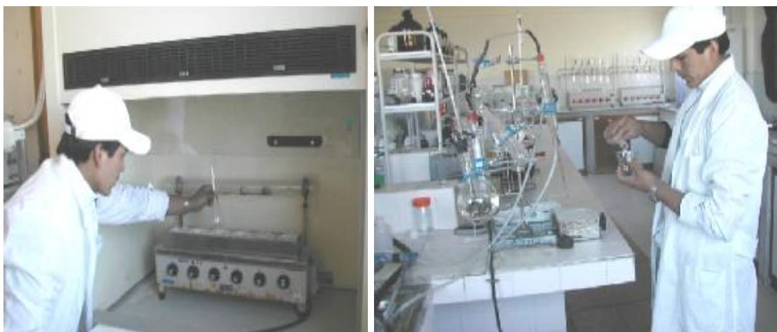
Figura 46. Determinación de proteínas por el método Kjeldahl.
