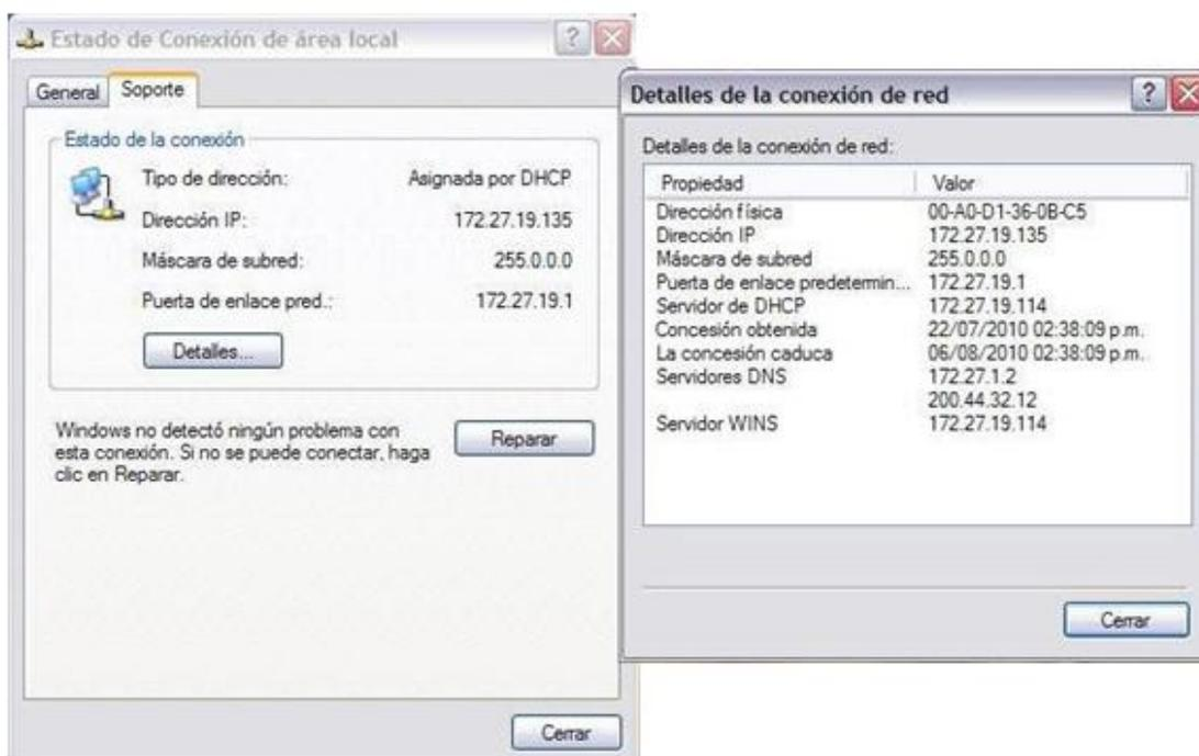
Fig. 3.2 Detalles de la conexión de Red
