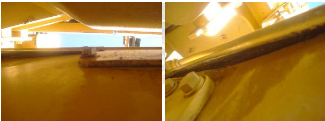
Housing del tandem roto en unión de soldadura y doblado.
