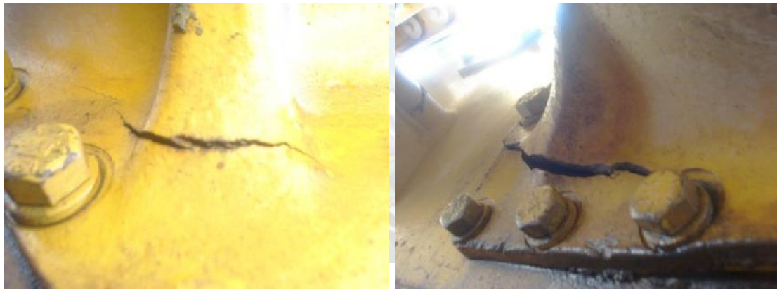
Soporte de eje de diferencial a tandem de ambos lados roto y doblado.
