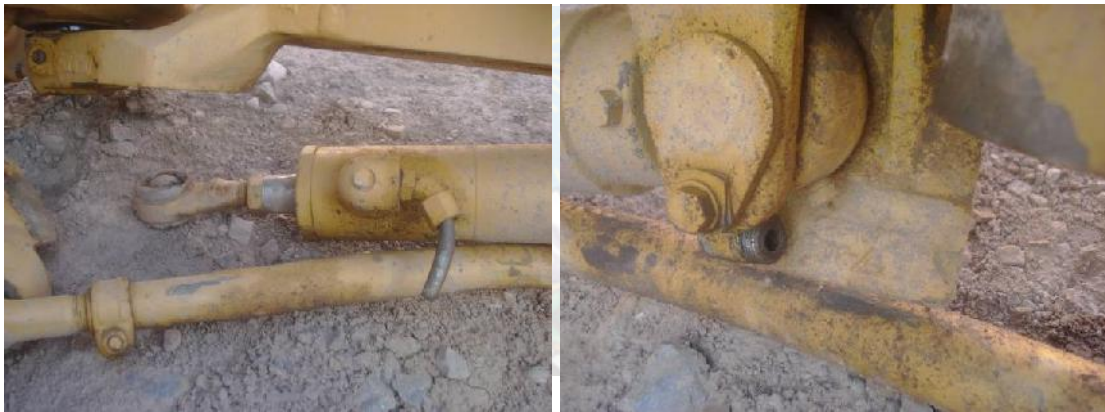
Cilindros de dirección con fugas y vástagos flectados.
