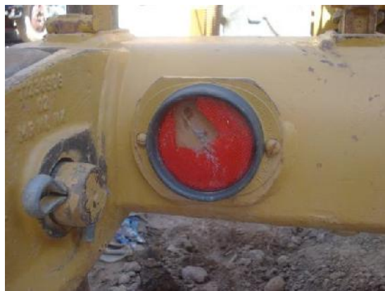
Reflectorio trasero izquierdo roto.
