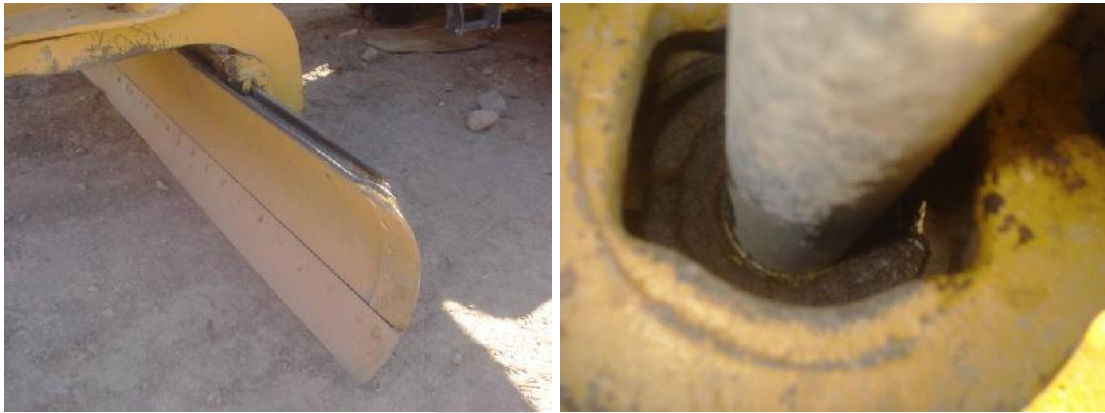
Cilindro de desplazamiento lateral de la hoja presenta fuga en los retenes.
