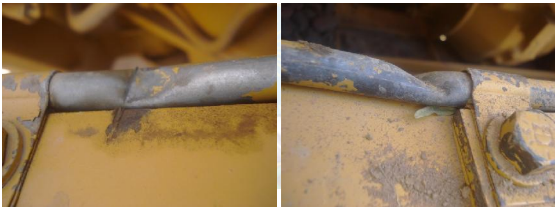
Líneas de aire de frenos doblas y rotas.
