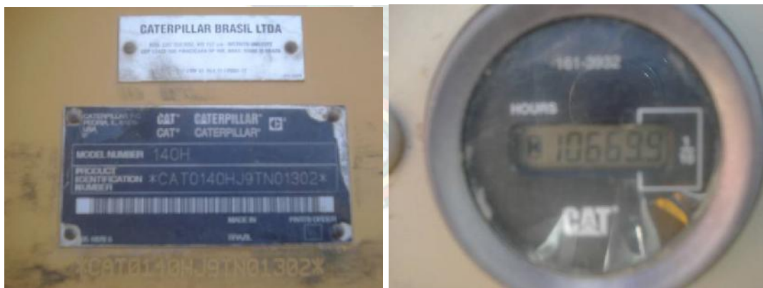
Placa de identificación de la máquina y horómetro.
