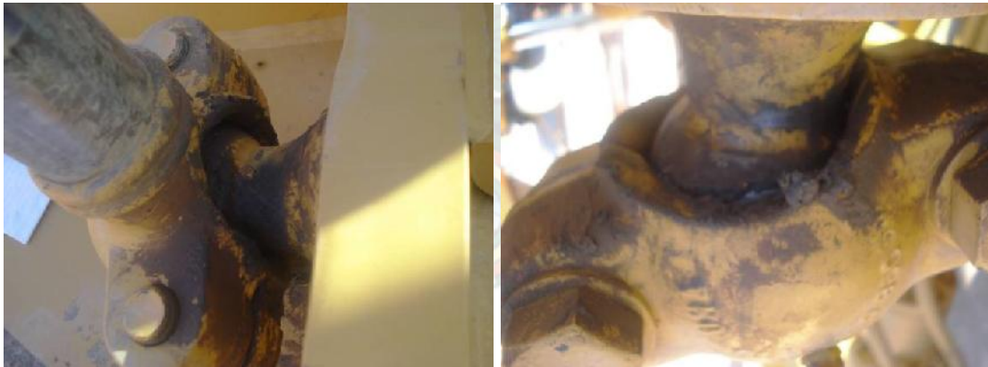
Articulaciones y puntos de engrase no engrasados o lubricados.
