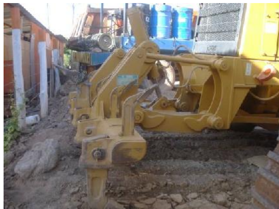
Uña de ripper central presenta desgaste excesivo.
