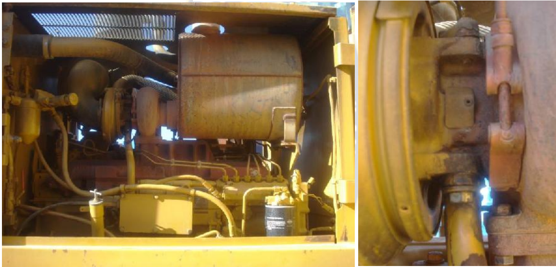
Turbo presenta fuga por línea de retorno
