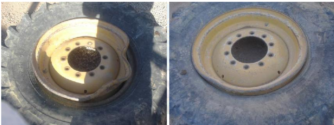
Ruedas delanteras dobladas, neumáticos desgastados.
