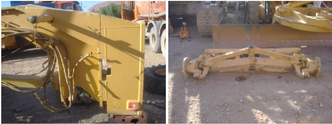
Tren delantero de dirección, mangueras de dirección rotas y piñón de sujeción y articulación de dirección roto. Además faltan faroles delanteros.
