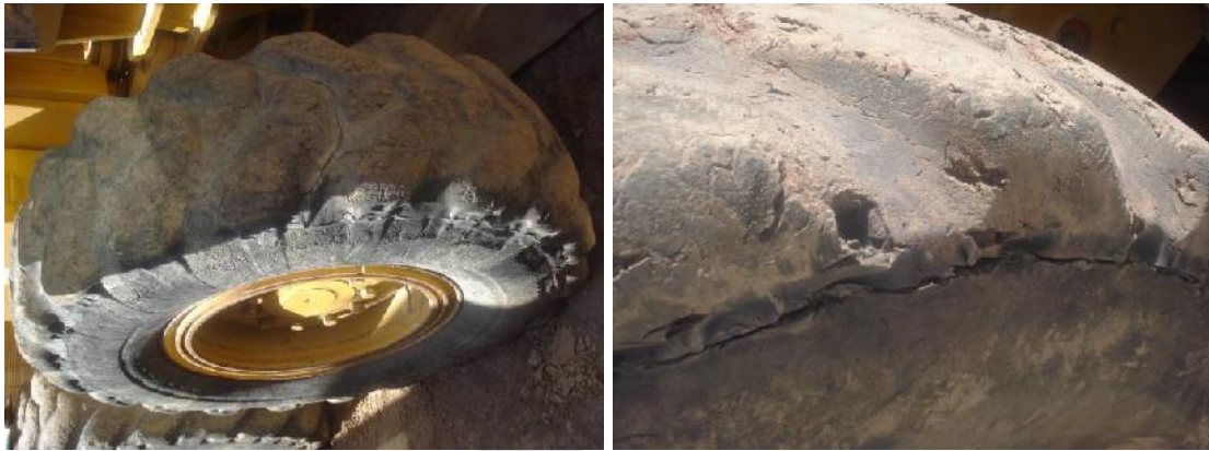
Neumáticos traseros presentan desgaste excesivo.
