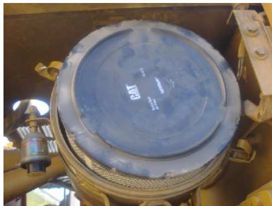
Filtro de aire primario obstruido por tierra.
