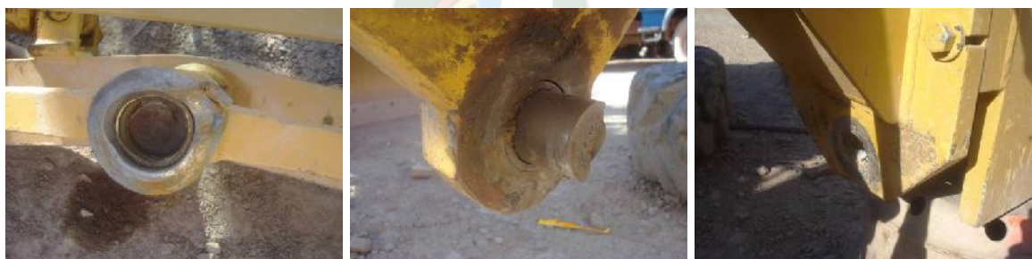
Eje pivote de tren delantero roto y soportes de chasis doblados y dañados por golpe y sobrecarga.
