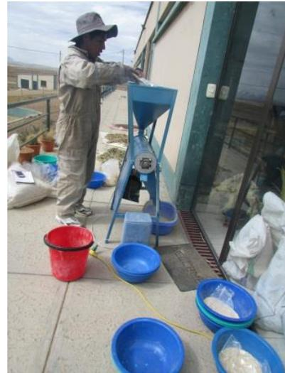
Fotografía 10. Saliendo los granos del cilindro escarificador.
