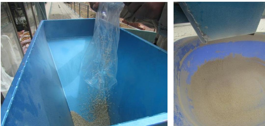
Fotografía 9. Proceso de escarificado de las muestras para eliminar la saponina por vía seca con la microbeneficiadora.
