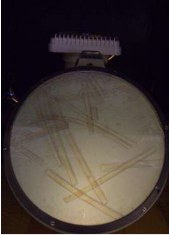
Fotografía 26. Lectura de muestras en el lanametro a 500X
