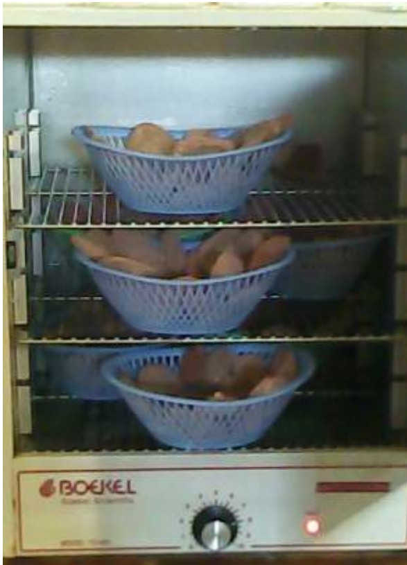
Fotografía 21. Secado de muestras en estufa
