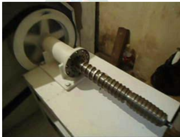
FIGURA 34. Tornillo simple de extrusión con sus tornillos intercambiables.
