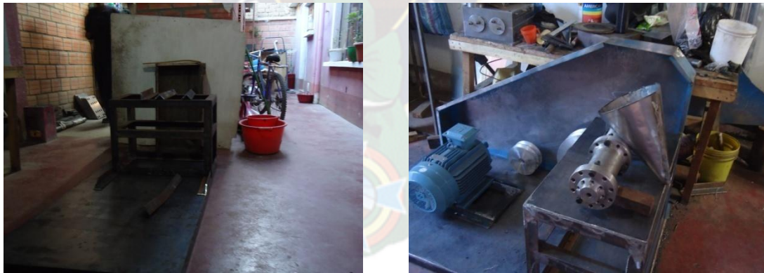
FIGURA 31. Piso y mesa del tornillo soldados y los elementos del extrusor.
