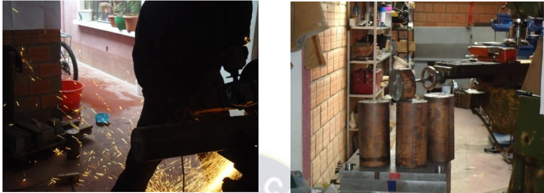
FIGURA 30. Cortando cilindro con amoladora y cilindros para camisas.
