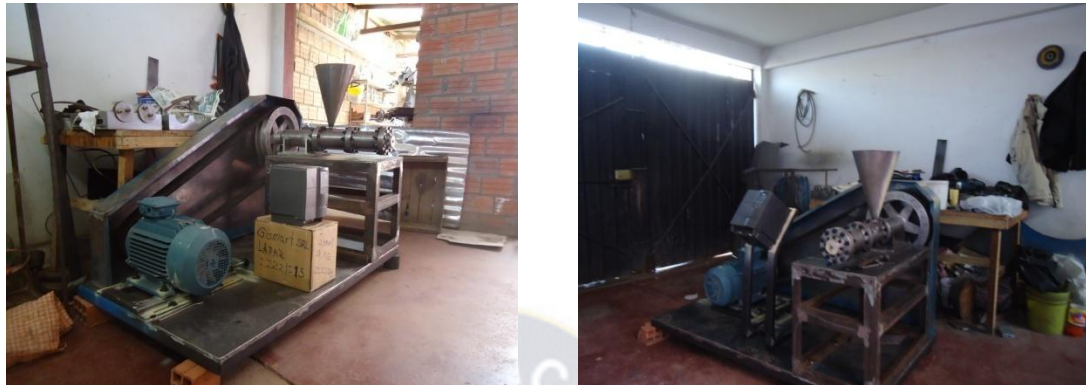
FIGURA 32. Elementos ensamblados del extrusor casi terminado.
