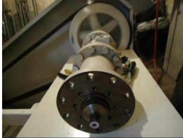
FIGURA 36. Tornillo simple de extrusión con su camisa de alimentación y camisa de amasado.
