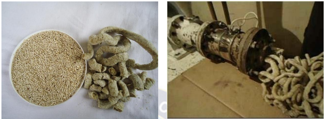
FIGURA 41. Quinoa preacondicionada y extruida.
