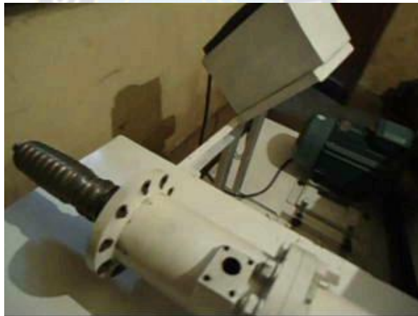
FIGURA 35. Tornillo simple y la camisa de alimentación.
