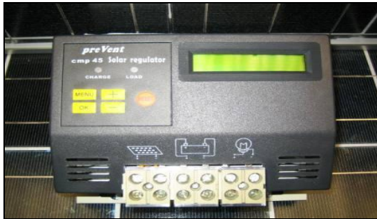
Figura 6.6 Regulador de carga fotovoltaico
