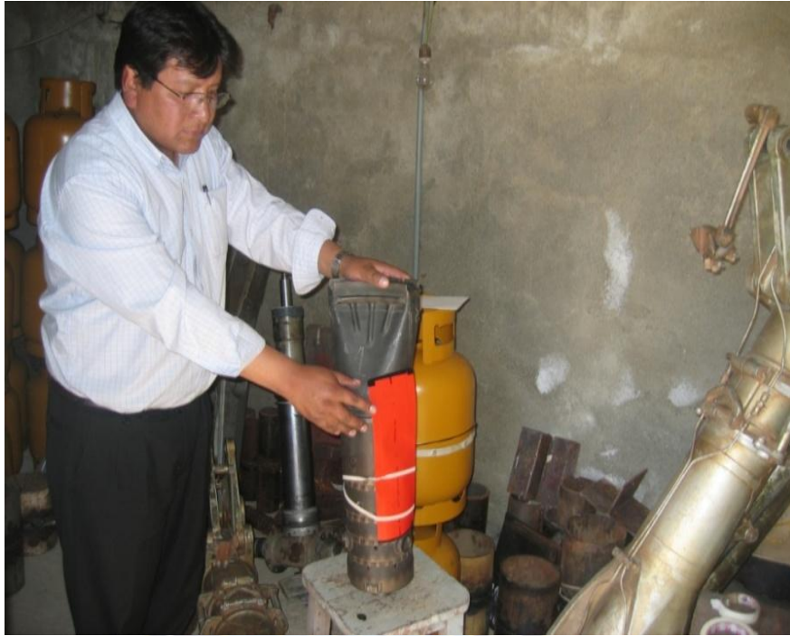
Figura 38: Inspección del 2º tubo de llama mediante el equipo de rayos x. (Fuente Propia)
