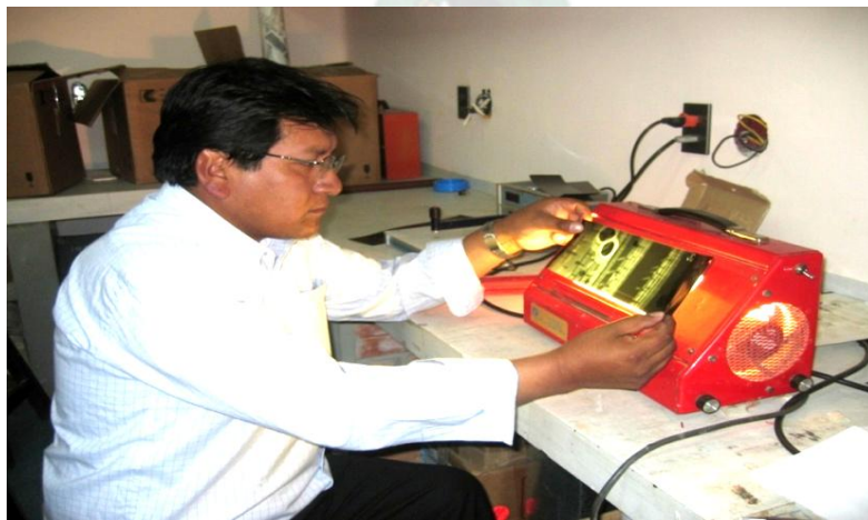
Figura 41: La película radiográfica del 2º tubo de llama se observa en el negatoscopio.
