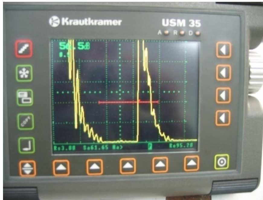
Figura 33: En el monitor se observa la señal de la superficie del 1° tubo de llama donde no existe distorsión entre los ecos reflejados. (Fuente Propia)
