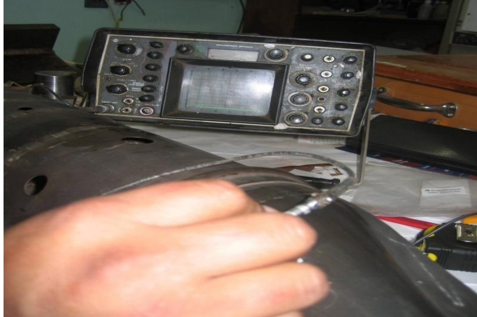
Figura 35: Inspección del 2º tubo de llama con discontinuidad con un equipo de ultrasonido adicional. (Fuente Propia)
