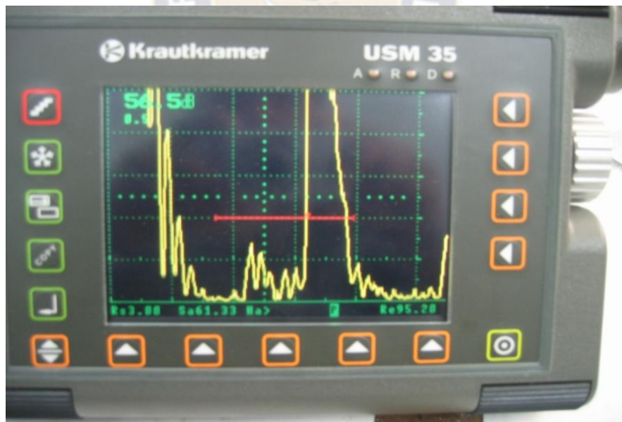
Figura 32: En el monitor se observa la distorsión de las ondas debido a la discontinuidad en la superficie del 2º tubo de llama. (Fuente Propia)
