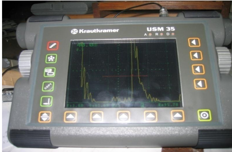
Figura 31: En el monitor se observa la distorsión de las ondas debido a la discontinuidad en la superficie examinada del 2º tubo de llama. (Fuente Propia)
