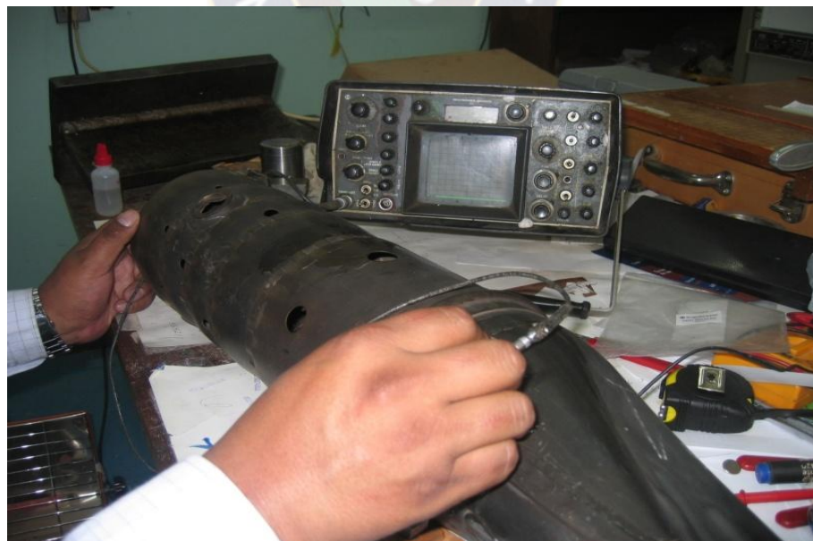
Figura 33: En el monitor se observa la señal de la superficie del 1° tubo de llama donde no existe distorsión entre los ecos reflejados. (Fuente Propia)
