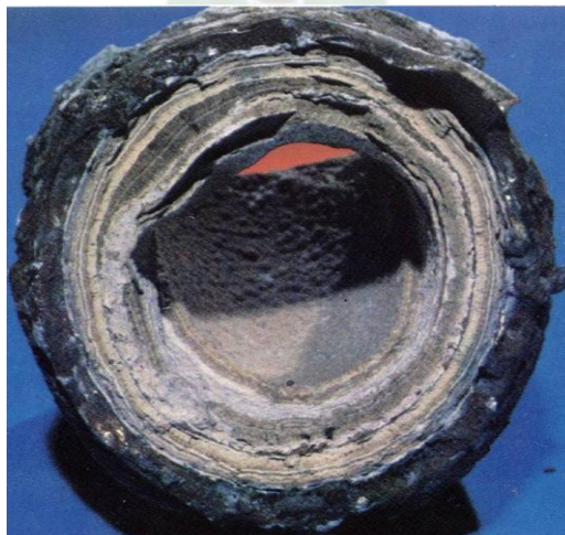
Figura 11. Depósito estratificado de diferentes compuestos debido a los depósitos en el lado del agua.
