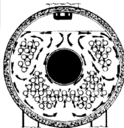
Figura 6. Circulación natural del agua en el interior de una caldera pirotubular. Fuente. SPIRAX/SARCO Principios básicos de la ingeniería del vapor.
