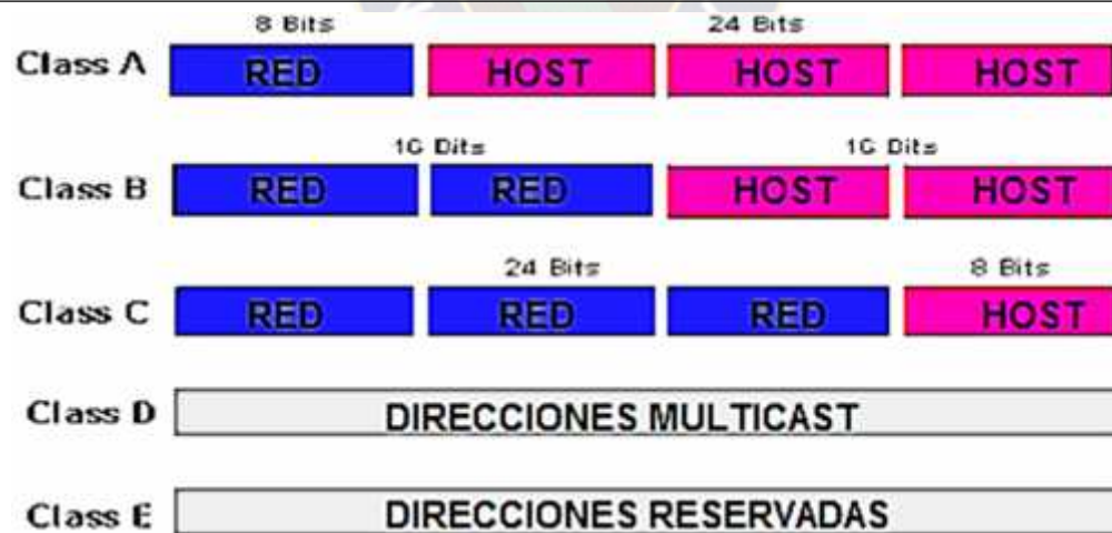
Figura. 3.3. Clases de dirección IP y sus rangos binarios Fuente: Guía de preparación para el examen de certificación CCNA. 1ra edición. Autor: Oscar Antonio Gerometta
