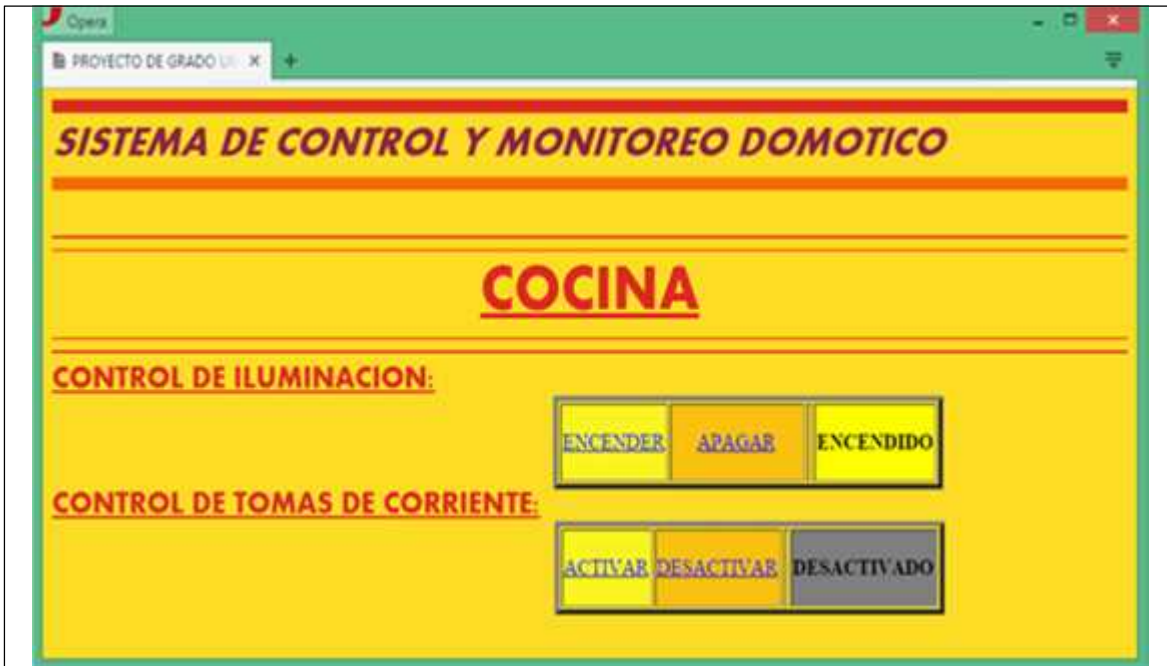
Figura. 5.48. Interfaz gráfica de la página menú Cocina Fuente: Diseño propio del Autor.
