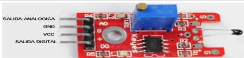
Figura. 5.27. Módulo sensor de temperatura NTC con salida digital regulable Fuente: https://tkkrlab.nl/sensors .
