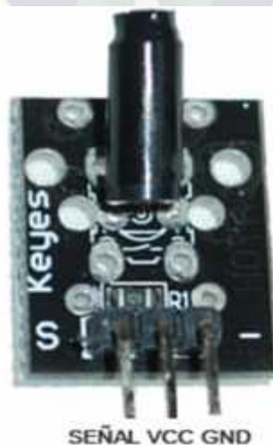
Figura. 5.22. Módulo sensor de vibración SW18010P Fuente: https://tkkrlab.nl/sensors .
