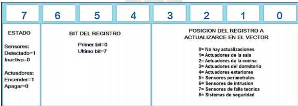
Figura. 5.38. Estructura del mensaje de un Byte Fuente: Diseño propio del Autor.
