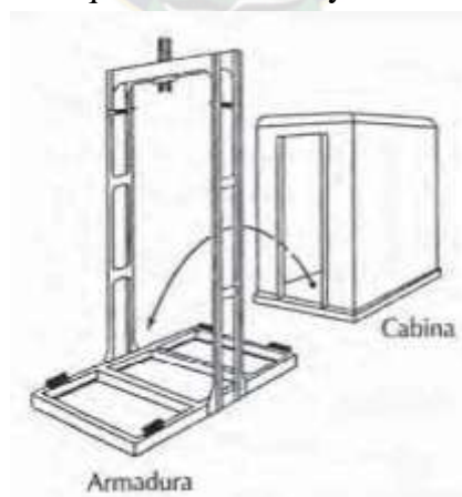
Figura 7. Esquema de cabina y bastidor o armadura
