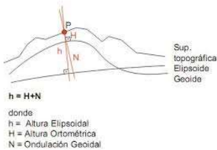
Figura II-18 Formas y determinaciones de las Superficies de Referencias en Geodesia FUENTE: Diplomado en SIG UMSA-2004
