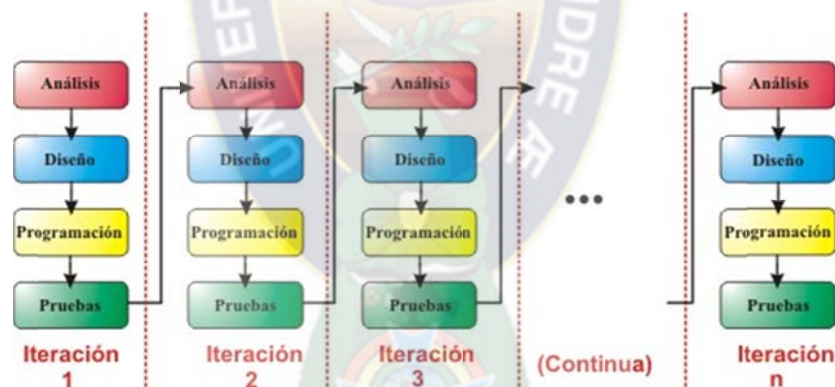
Figura 2.3: Ciclo de vida del método iterativo [Fuente: Lehman, M.M.]
