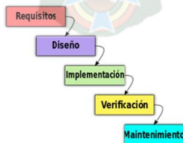
Figura 2.2: Ciclo de vida del modelo en cascada [Fuente: Lehman, M.M.]
